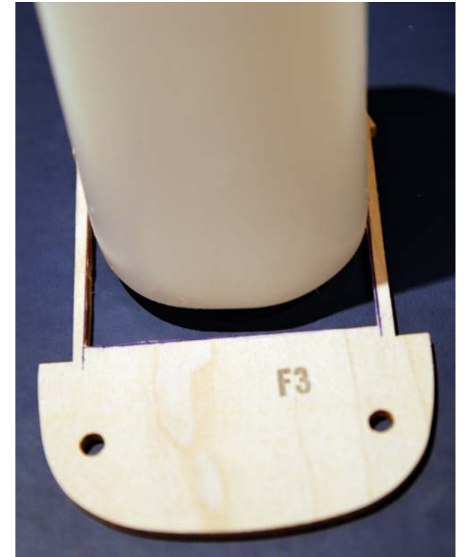
Modellen ska elektrifieras så ett spant fick sågas ut för att rymma ett sexcellspaket. Obs, på bilden syns originaltanken.
