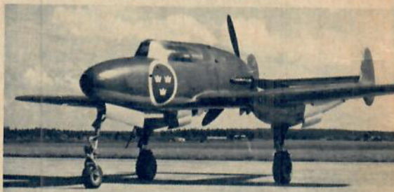
J 21 , Saab, Daimler-Benzmotor på 1.475 hk, toppfart cirka 650 km/tim.
