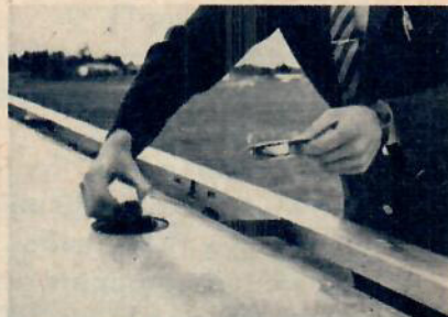
Tankning och bränslekontroll är enkla, eftersom tankarna ligger de lågt placerade vingarna.
