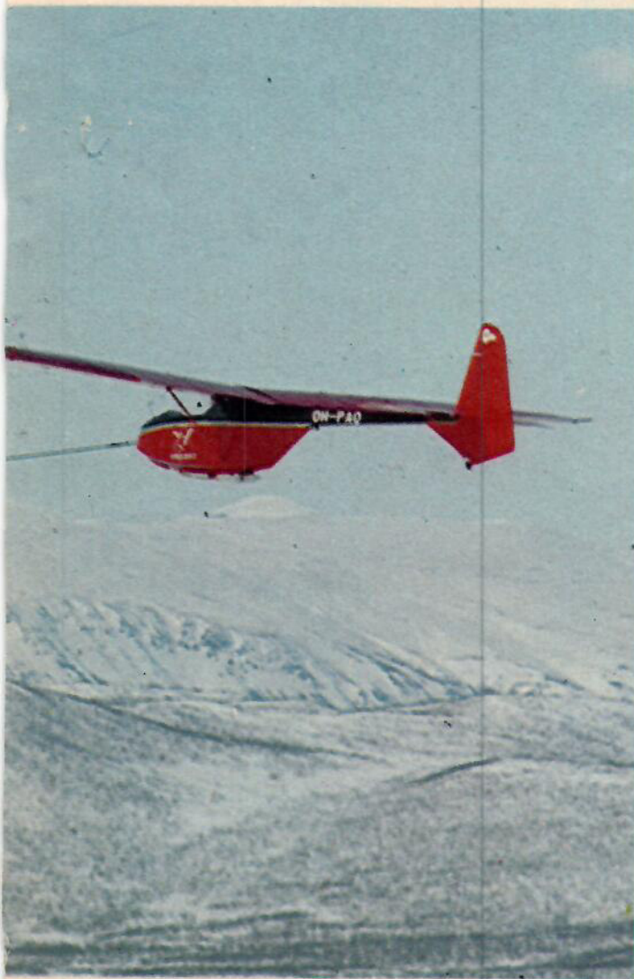
Klart för start! En finsk Pik 5V får hjälp på vägen, dvs. isen, av villiga händer. Lägg märke till den enkla bakkroppen som bara består av en bom.
