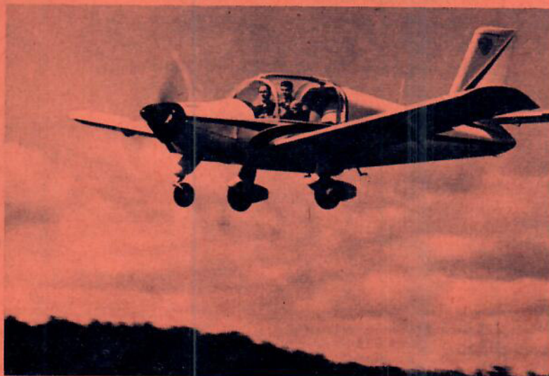
Titta på Olle Ringstrand i förarsitsen. Så högt sitter alltså piloten i förhållande till vingar och nos. Resultatet blir en sikt som är mycket ovanlig i småflygplan.
