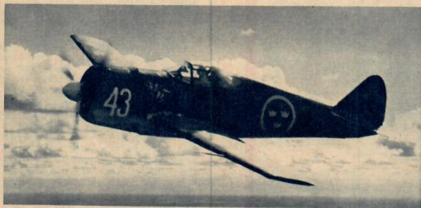
J 22 byggdes vid Flygförvaltningens verkstäder på Bromma. Flygkroppen till största delen i trä. Svensktillverkad Twin Wasp-motor. Fart cirka 570 km/tim.
