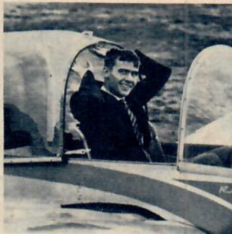
Plexiglashuven är bekväm att stänga — men tyvärr är det lätt att slå huvudet i framkanten.
