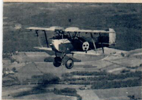
J 1 Phoenix 122 var utrustad med antingen en Hiero på 240 hk eller en BMW på 185. Med den svagare motorn gjorde planet cirka 170 km/tim.
