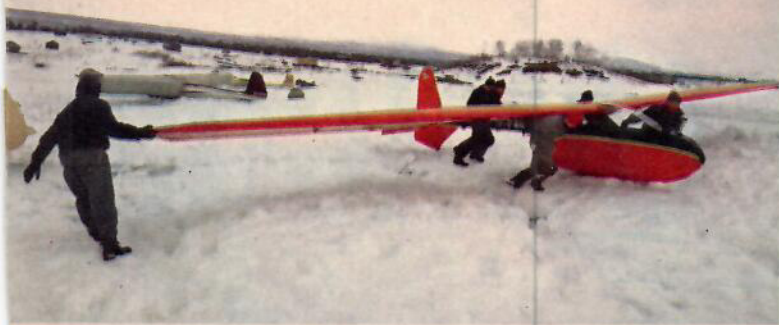
Klart för start! En finsk Pik 5V får hjälp på vägen, dvs. isen, av villiga händer. Lägg märke till den enkla bakkroppen som bara består av en bom.
