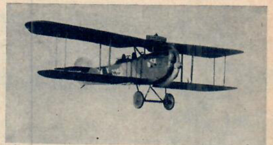
S 1 Phoenix C 1 hade en Maybach motor på 260 hk, toppfart 170 km/tim och var utrustad med 2 kulsprutor.
