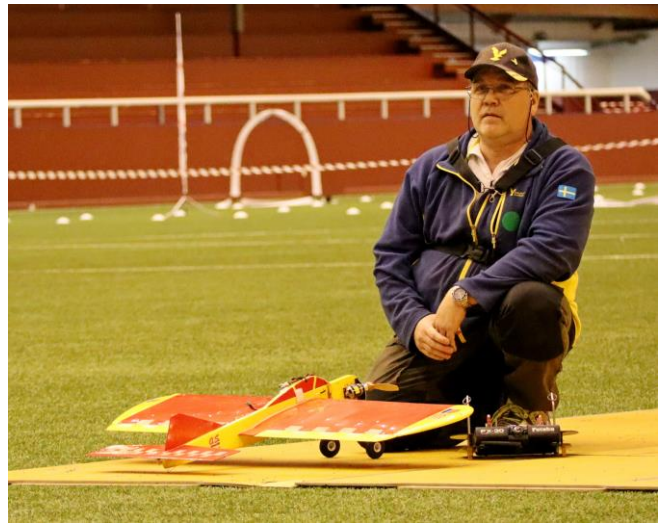
Radion används för att starta och stanna motorn.
