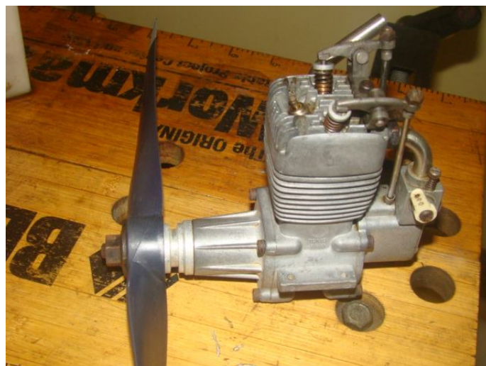
En Kalt 45. Tillverkades av en firma som gjorde modellhelikoptrar. Första versionen saknade en fungerande vevhusventilation.
