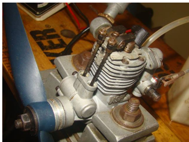
En liten ASP 30. För att göra den lite intressantare har jag med bågfil och vanlig fil tagit bort kåpor och annat material runt vipparmar och ventiler.
