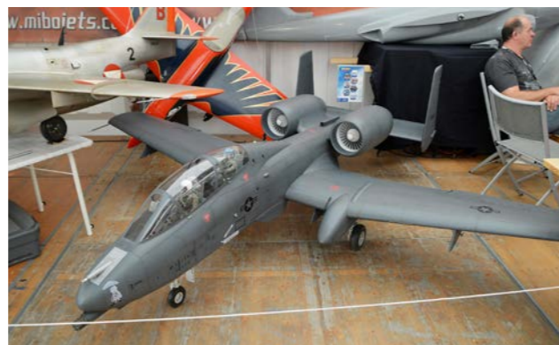
MIBO YA-10B längd 2,75m, vingspann 3m, vikt 21Kg, bränslet 2x2,7l, skala 1:5,8
