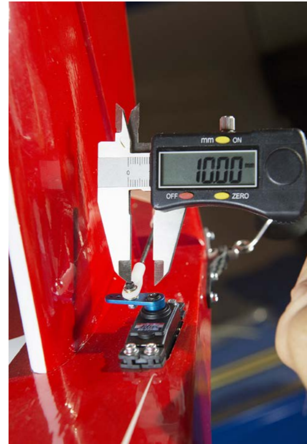
Till höjdrodrets servook bytte jag till 10mm i radie och det var fortfarande för mycket om man vill komma upp till 100% arbetsområde på höjdroderservot.
