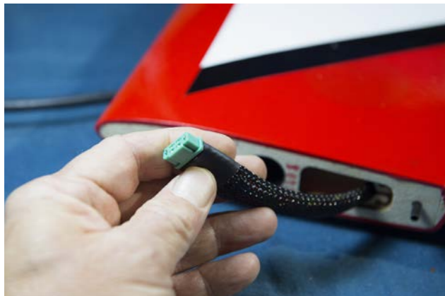
Jag lödde på skarvkablar på skevroderservot och sedan lödde jag på en MPX6 kontakt vid vingroten för att man enkelt skall kunna koppla vingen i kroppen utan att riskera fel vid hopmontering på fältet.
