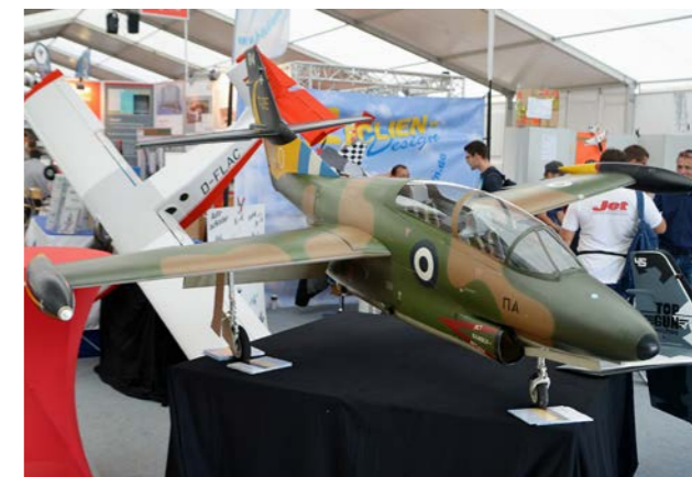
Paritech T-2C Buckeye, skala 1:4, spännvid 2900mm, längd 2950mm, vikt 21Kg, turbin 16-20Kg
