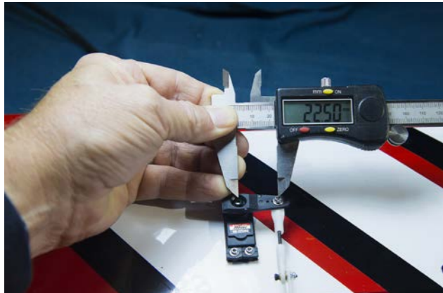
Radien på klaffservots ok har en radie på 22,5mm
