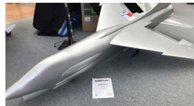
Paritech F-8 Crusader, skala 1:6, spännvid 1810mm, längd 2768mm, 17Kg med 5l jet A1, turbin 16-20Kg
