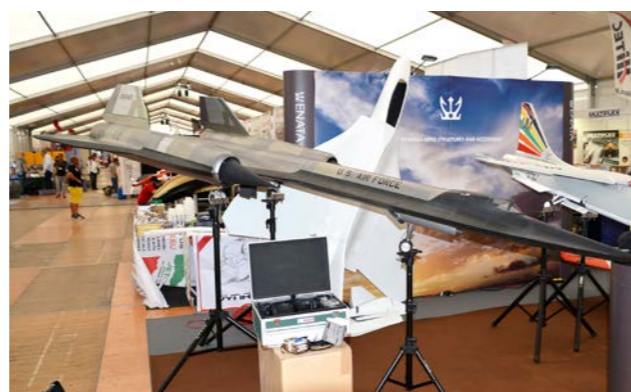
En SR-71 Blackbird i skala 1:8, längd 3,96m, vingspann 2,08m, med en vikt på 19,9Kg och med en 7l, alt. 5l bränslet tank. 2x10Kg eller 2x 14Kg turbin
