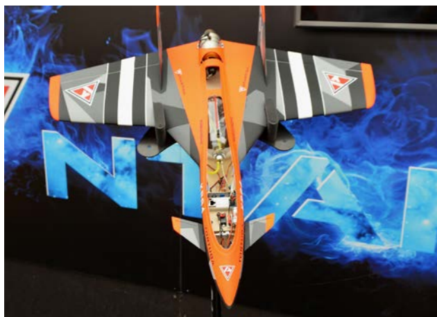
SAB Avio Antartica Tortuga, vingspann 84cm, längd 81cm, vikt 1,55Kg. Elektrisk motor, alternativt med turbin
