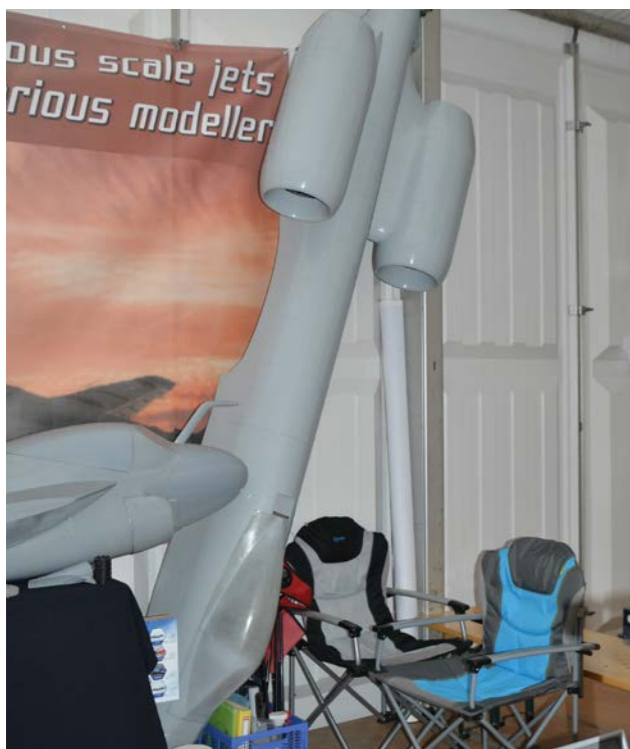
MIBO A-10 längd 4,06m, vingspann 4,38m, vikt 70 Kg, bränslet 15l, skala 1:4
