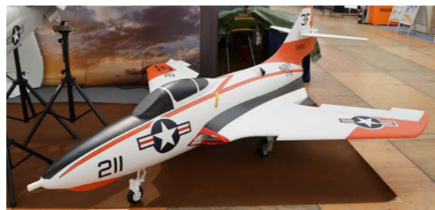
Och slutningen en Grumman F9F-8 Cougar i skala 1:3,8; längd 3,28m, vingspann 2,77m, vikt 20-30Kg, 40Kg turbin
