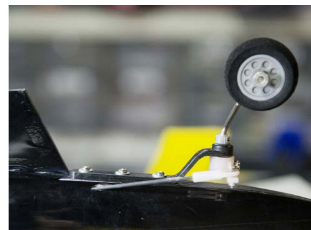
Sporrhjulet styrs med en stötstång till samma servo som sidrodret.
