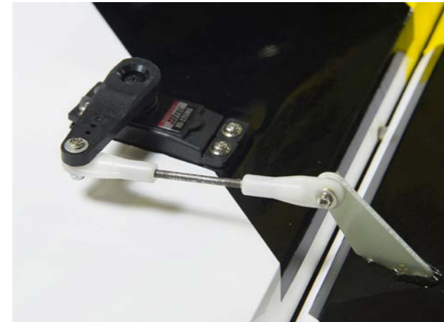
Stötstången monteras på servookets undersida för att kunna få maximala roderutslag.
