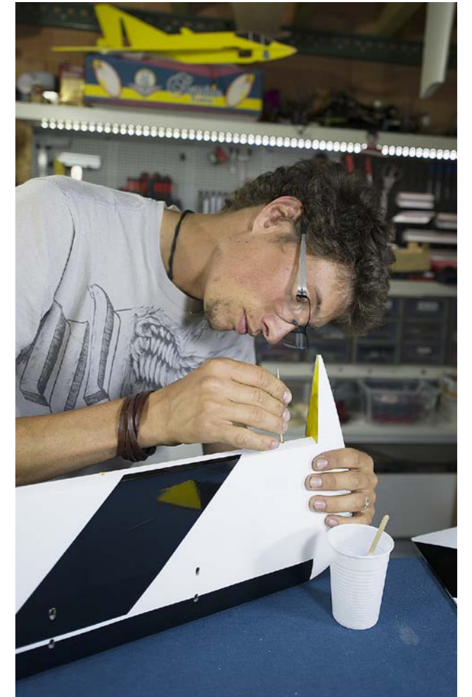
Thomas trycker in epoxy för att kunna limma fast pinngångjärnen
