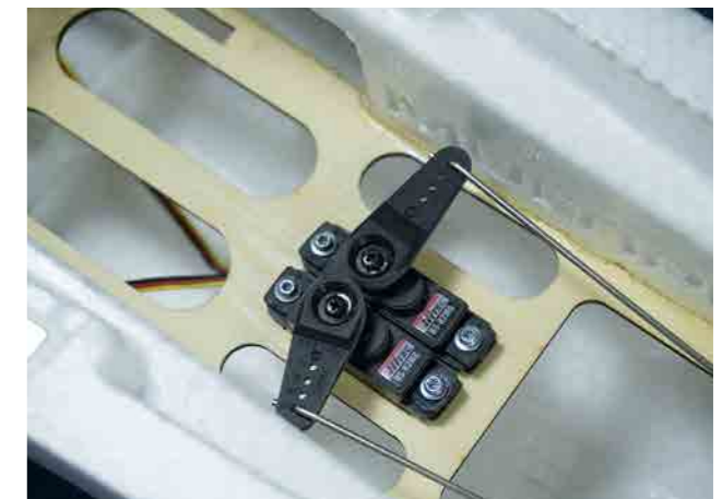
Hitec HS-82MG servonen kompletteras med större servook som kommer med i byggsatsen.
