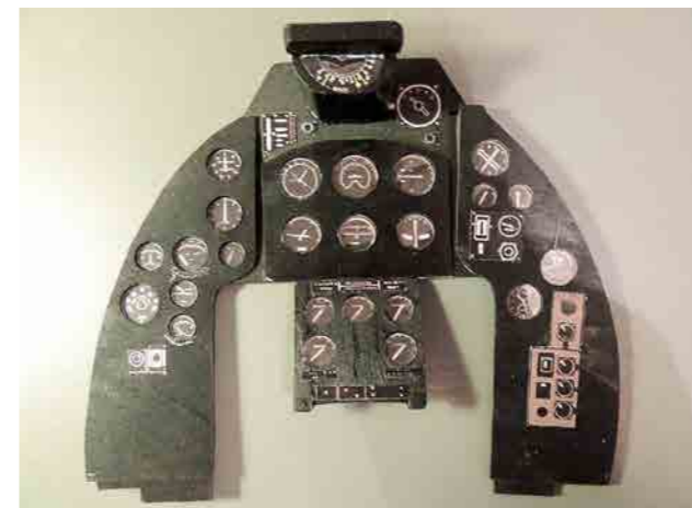
Därför blev valet att försöka få en instrumentbräda med de huvudsakliga instrumenten på rätt plats. Instrumentbrädan gjordes dessutom delbar så att den lätt skall kunna tas ut. Detta eftersom vi vill utnyttja utrymmet i nosen till att placera batterier och andra delar som väger lite, allt med tanke på tyngdpunktsläget.
