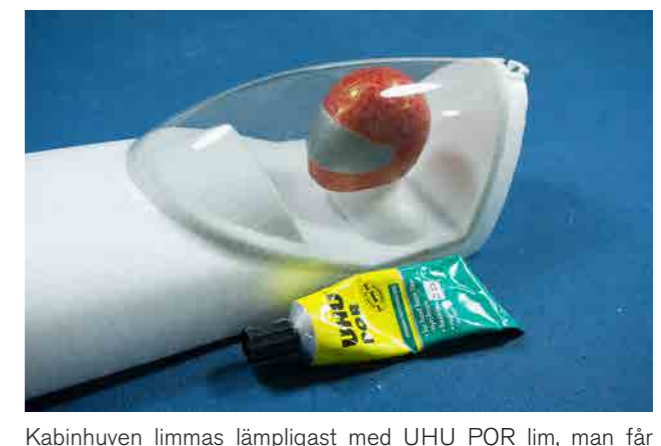
Kabinhuven limmas lämpligast med UHU POR lim, man får vara lite försiktig så att man inte kladdar bredvid. Det går även att använda CA-lim, men CA lim riskerar att ge vita märken på huven då den torkar.
