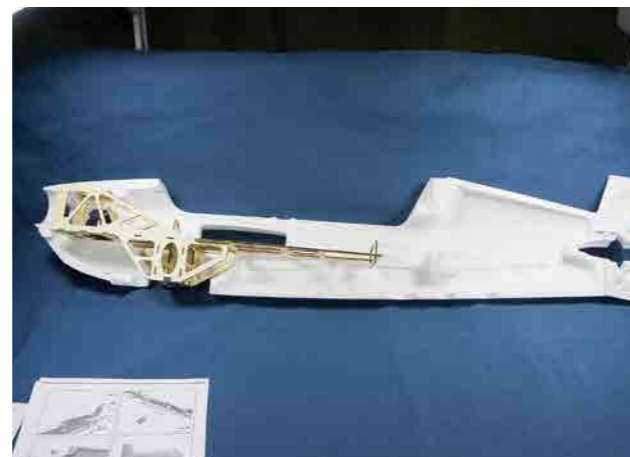
Kroppen har en förstärkning i form av ett "skelett" i plywood, denna konstruktion gör att modellen blir väldigt stryktålig.
