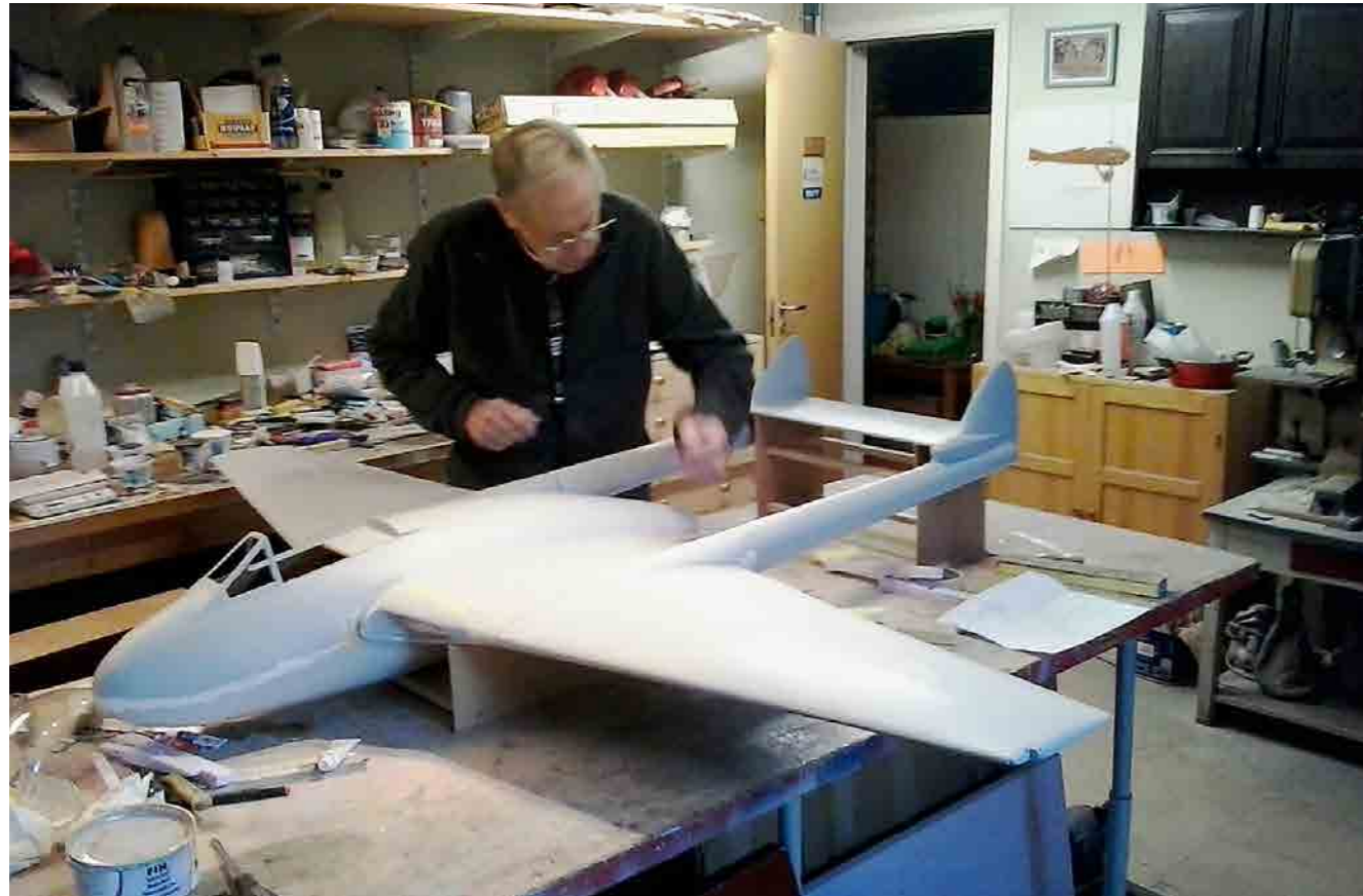
För att få vinklarna mellan kropp, bommar och stabilisator rätt så har vi en jigg där delarna kan fixeras.
