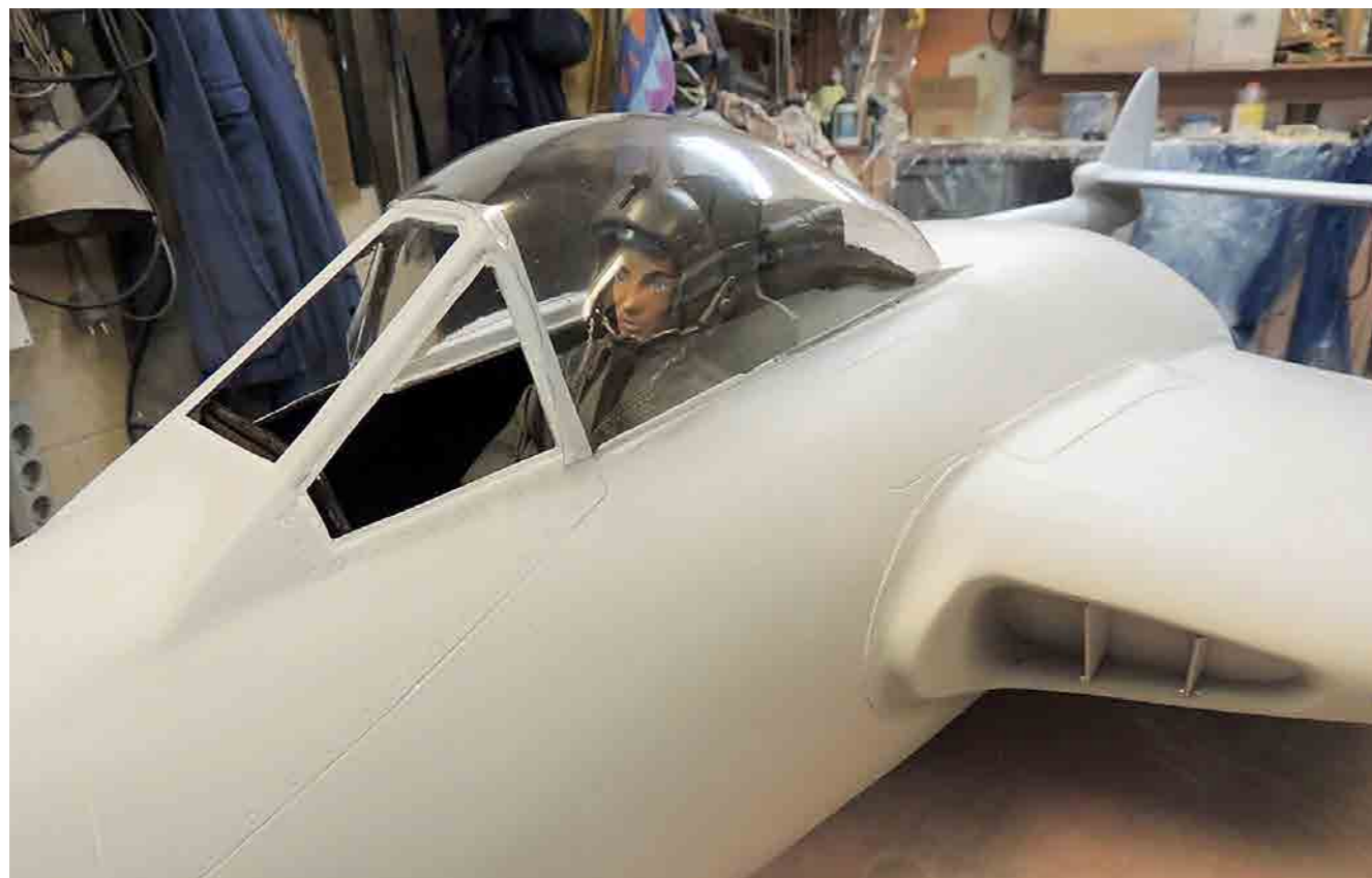
För att tillverka huvan till cockpit så har vi gjort en plugg med den rätta formen och sedan "dragit" en huv av plast över formen. De övriga rutorna – framrutorna – är plana och monteras från utsidan (som på originalflygplanet) mot den kant som vi har kvar i glasfiber materialet.
