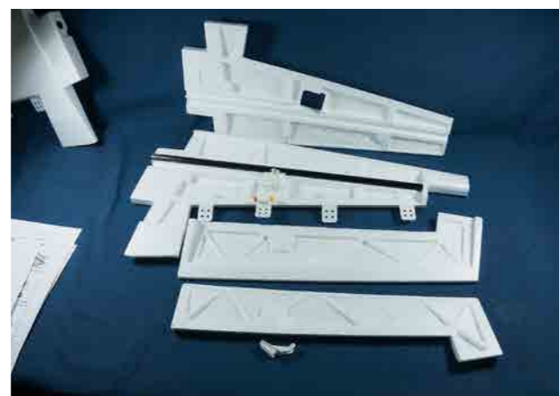
Vingarna består av under och översidor för att de skall kunna lättas upp maximalt.
