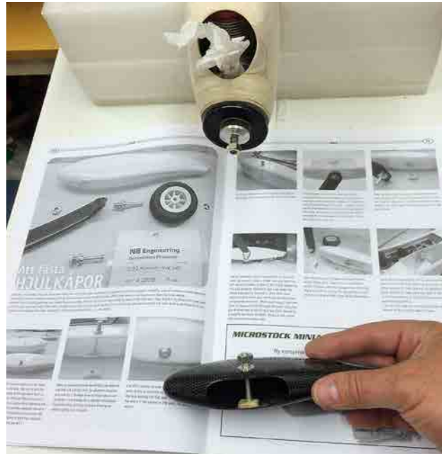
Ibland hittar man hjälp i ett gammalt nummer av Lina! Här fann jag ett bra tips på hur man fäster hjulkåporna mot landningsstället.
