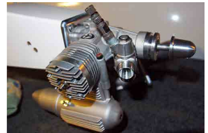
TT40 väger ca.40 gram mer än Nelsonmotorn. Något bly i bakkroppen kan behövas med den i nosen.
