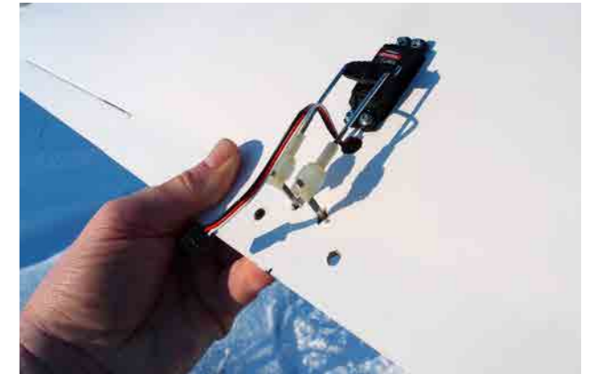
Enkel och okonventionell skevservomontering.
