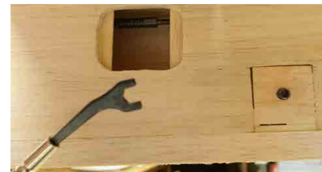
Jag har byggt in många möjligheter att trimma modellen. Genom att skruva på stötstängens som går mellan flaps- och höjdroderhorn med verktyget kan jag ändra stötstängens längd och därmed rodrens inbördes läge. Luckan nere till höger döjer ett utrymme för blyvikter.
