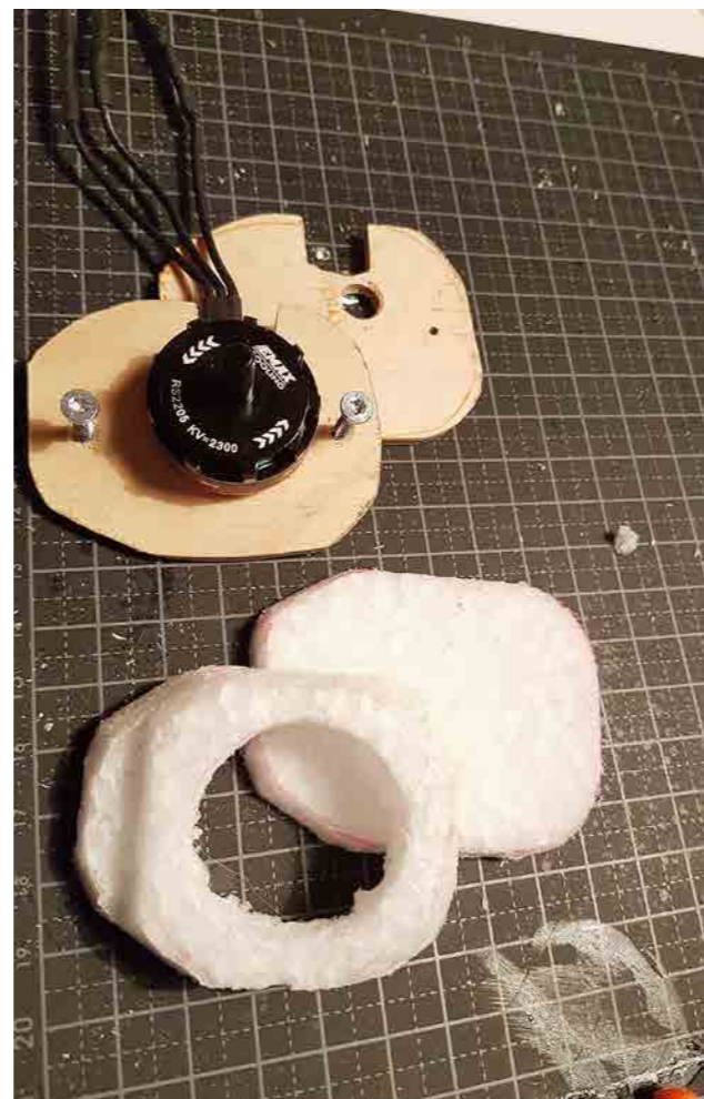
Främre delen av kroppen skärs loss för att bli motorkåpa. En skiva lika tjock som motorspantet skärs sen loss och ersätts med motorspantet.
