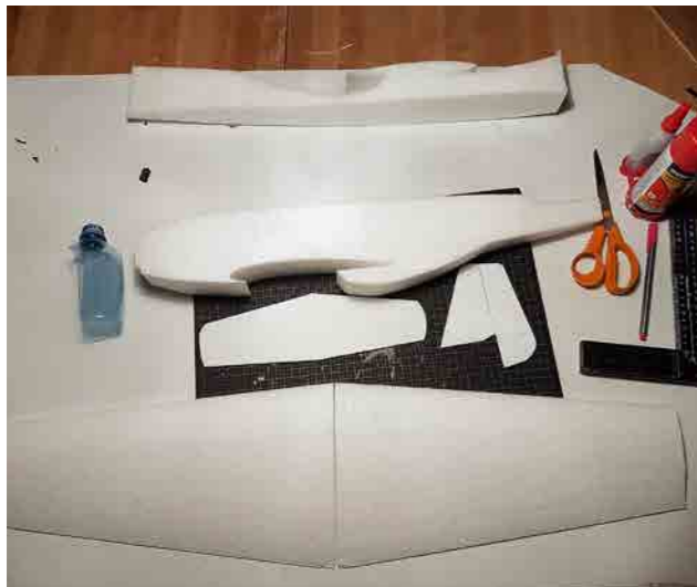
Modellen plastdelar – kropp och vinge i EPP, stabbe och fena i kanalplast.
