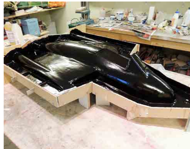
Nu kunde vi gå vidare och bygga kroppsformarna. Vid delningsplanet så byggdes kanter och sedan målades hela kroppen med gelcoat.
