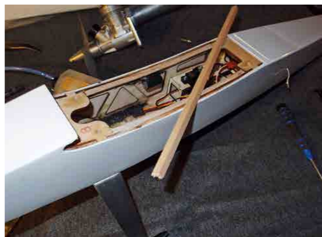
Jag limmade dit trekantslister på kroppsidorna för att göra vingsadeln bredare. Inte nödvändigt kanske men man slipper fula märken i vingen.
