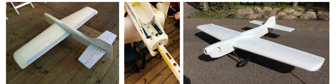
Jag använde vit dope som grundfärg och spredade lite extra på de områden som skulle vara fortsatt vita så som linjer, text, stjärnor m m.
