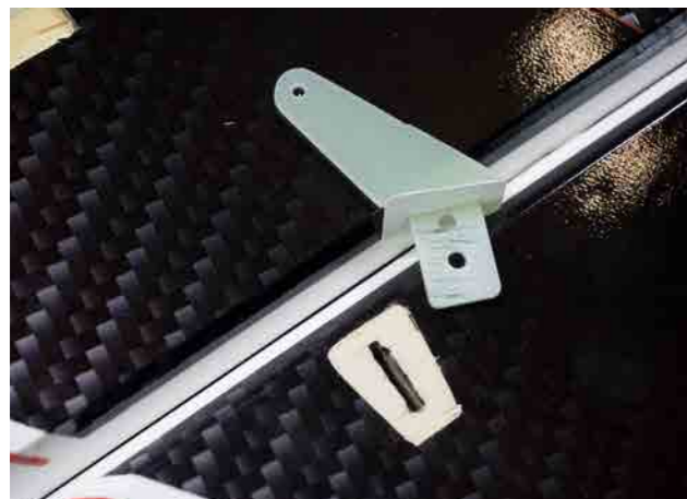
Roderoken slipas matta och klädseln skärs upp lite för att epoxylimmet skall fästa bättre.
