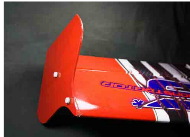
SFG går att skruva fast med M3 skruvar, man jag hade skruvar som lätt går att skruva in för hand utan verktyg.
