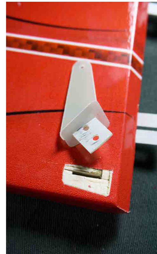
På sidrodret måste man vara försiktig så att man inte skär upp klädseln för mycket, men det varnas för det även i manualen.
