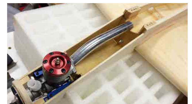
Motorn kläms fast i modellen med hjälp av plattor av aluminium. Det ska bli underlättat om man vill byta till annan typ av motor.
