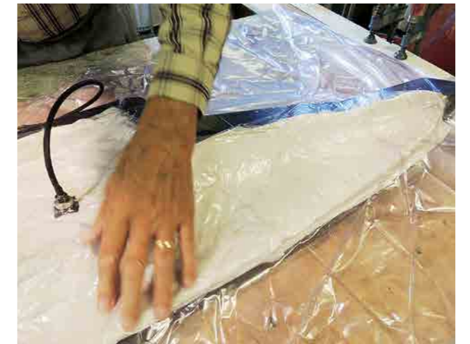
Allt detta sätts sedan in i en vakuumpåse och en pump ansluts. Pumpen får stå på i 10 timmar.
