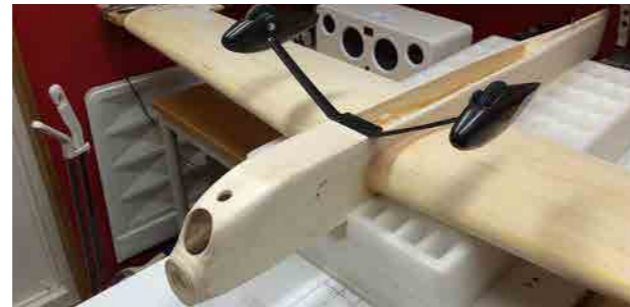
Landningsstället är alltid ett gissel att montera rakt. Man får mäta och använda ögonmått så gott det går. Stället och hjulkåporna är gjorda av kolfiber och kommer från Aero products.
