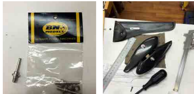
Lätta hjulaxlar av aluminium från BN Models. Landningsställ och hjulkåpor av kolfiber sparar också vikt.
