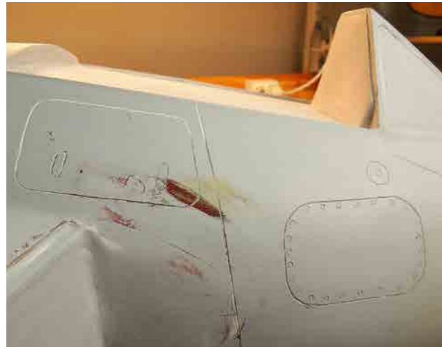
Ytan på den pluggen kläddes sedan med glasfiber och spacklades till så god jämnhet som möjligt. Vi grundmålade pluggen och passade på att rista in luckor, skarvar, nitar och skruvar i pluggen.
