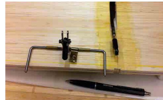
Flapshornet limmas fast i vingen med epoxy.
