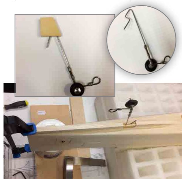
Sporrstället är av en konstruktion som medger enkel demontering. En konstruktion som tyvärr blir utsatt för olja från avgasströmmen så jag gör nog på annat sätt vid nästa bygge.
