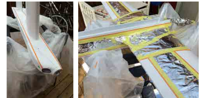
Maskeringstejp av plast i olika bredder och aluminiumfolie användes vid maskeringsarbetet tillsammans med en stor portion tålmod.
