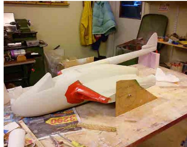
När man avser att göra formar för gjutning så är det ytterst viktigt att tänka på delningsplan och släppvinklar. Av den anledningen fick vi bland annat göra luftintagen separat.
