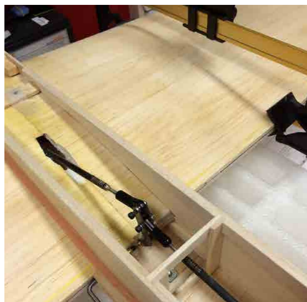
Här ska strax stabben limmas på plats. Notera att de traditionella kroppsspanten bytts ut mot "uppbyggda" där fiberriktningen ger ett starkare slutresultat.
