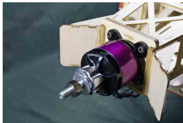
Balsabitarna som kommer med i lådan, men som inte finns med i byggbeskrivningen är till för att leda luften som kommer in i motorkåpan till motorn.
