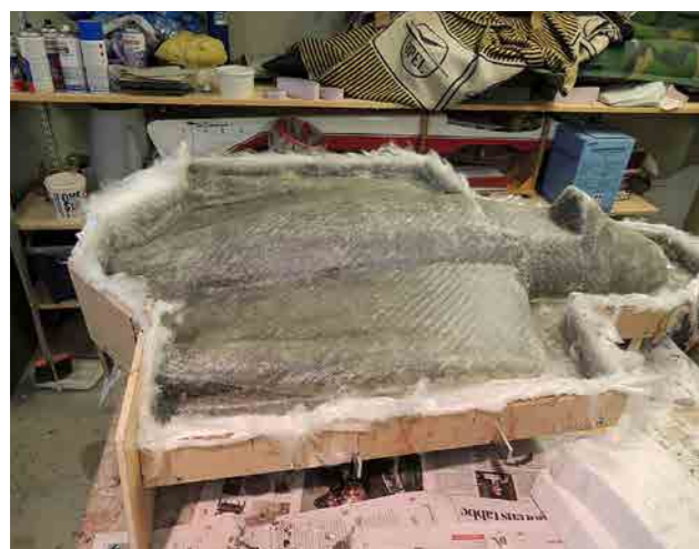
Därefter la vi på epoxiplast och flera lager glasfiber för att få en stabil form
