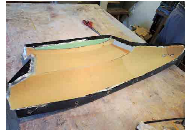
Kroppen består av 3 formar. En överdel och 2 underdelar. 2 underdelar är på grund av släppvinklar så att det blir möjligt att ta ur pluggen från formen. Nu skall formen vaxas ett antal gånger – med härdtid mellan varje lager av vax. Släppmedel stryks på och sedan kan man börja bygga upp laminatet i formen. Det blir flera lager glasfiber och ett lager distansmaterial.
