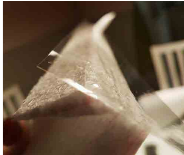
Skevroder skärs ut ur EPP:n och sen tejpas "gångjärnet" på plats.
