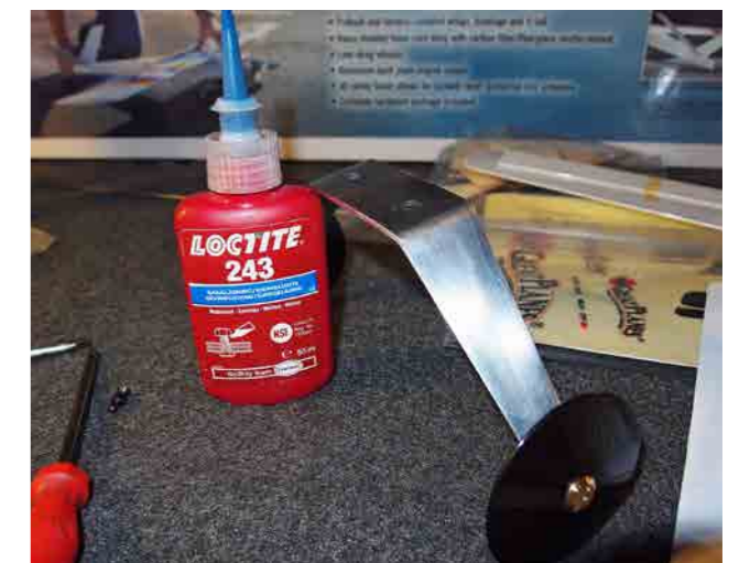
Och så blir det ju snyggare. Lås skruvar och muttrar med Loctite.
