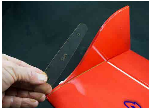
Det medföljer en genomskinlig distansbricka som är användbar om skevroddren tar i SFG.
