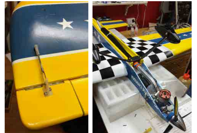
Trimtab - behövs tills den dag Enya 61 CXRS PRO är en ganska då jag kan bygga 100% rakt. ny och obeprovd stuntmotor men har visat sig fungera bra.
