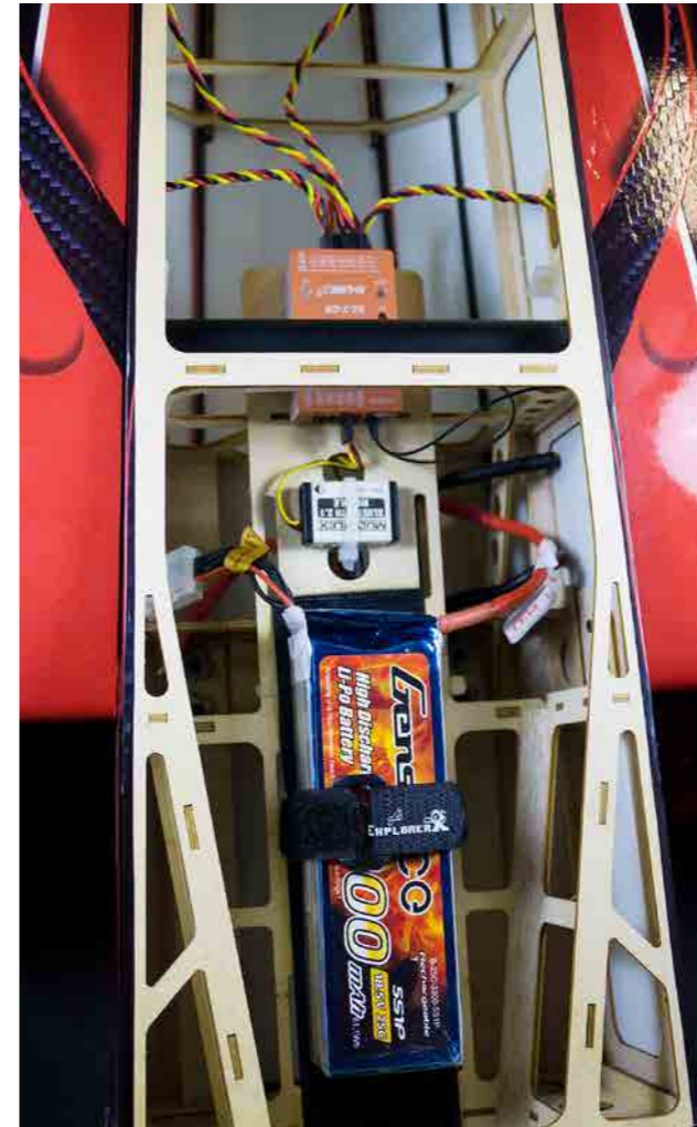
Installationen i Demonstratorn, väldigt ren och enkel.
