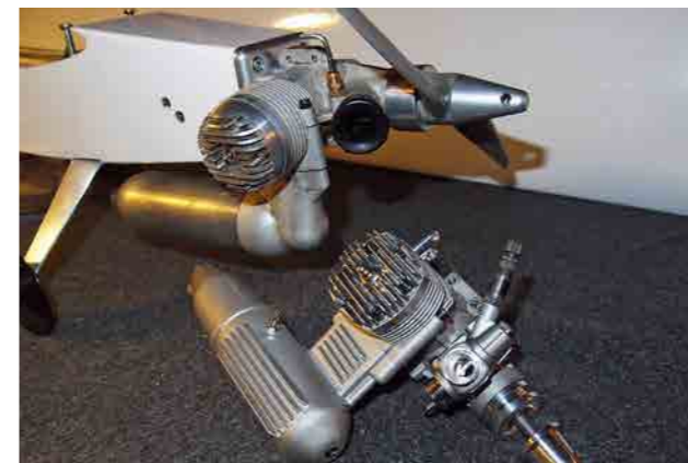
Nelson LS eller TT 40 Pro. Bara att välja, bägge passar tack vare baklocksfästet som följer med satsen.
