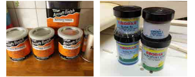
Randolphs Butyrate dope skickades efter från Arigo Teknik. Färg och lack säljs i burkar om 1/4-gallon eller mer. Till vingrotsutfyllnad användes Aeropoxy Lite som är ett extremt lätt epoxyspackel från Brodak. Deras Super Fil är en snarlik produkt.
