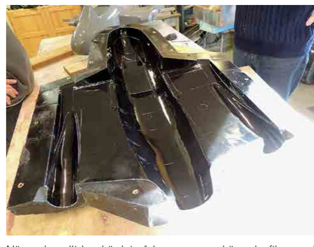
När sedan allt har härdats så kan man renskär glasfibern och öppna formen för att ta ur pluggen. Det här är ett spännande ögonblick. Har allt gått bra? Ser formen bra ut
