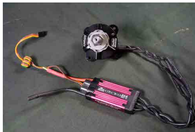
Drivlinan, den rekommenderade Hackermotorn och sedan valde jag Geckos 65A fartreglage med en BEC som klarar 8A belastning.
