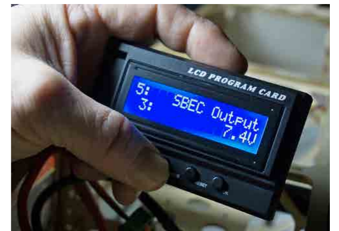
Gecko fartreglagen programmeras enkelt med en handhet.
