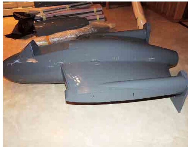
Till slut så målades pluggen med 2-komponents härdlack
