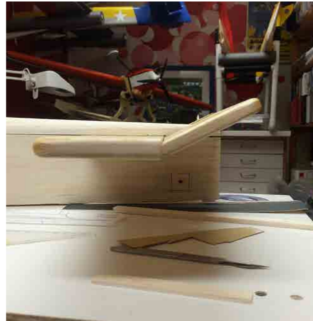
Detta är höjdrodrets maxutslag. Flapsen och höjdrodret har utslagsförhållandet 1:1.
