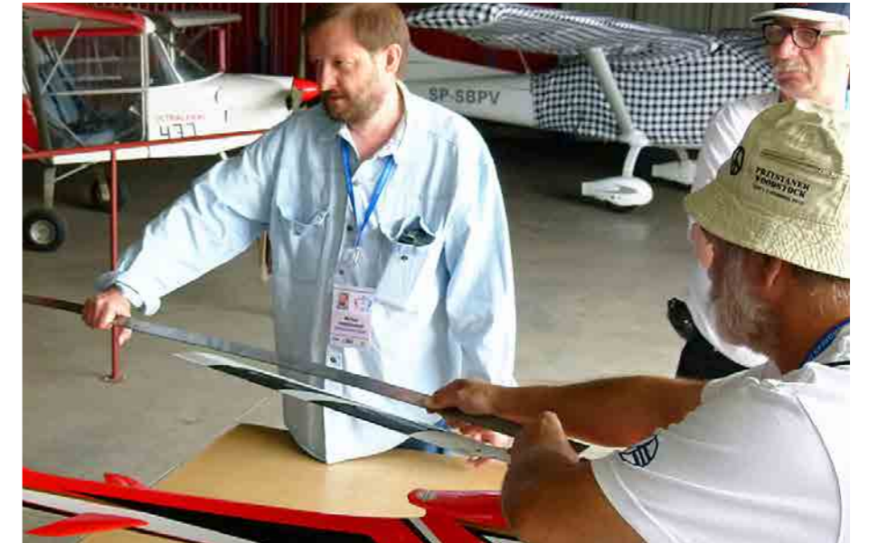
Mätning av rotorytan. Får max vara 250 dm 2
