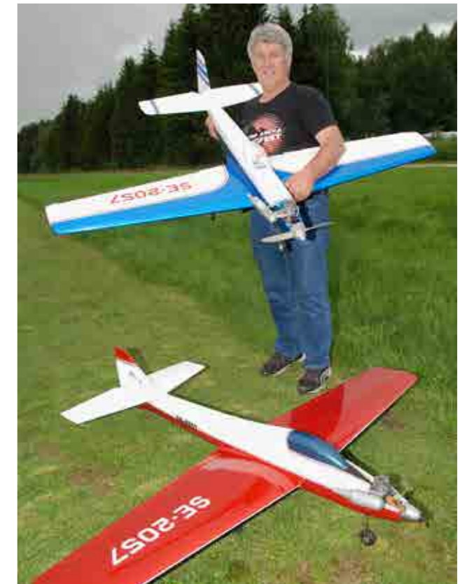
Kenneth Holmgren är med i Tierps modellklubb. Till Dragsängarna kom han med en nybyggd Mach 1 och en Tiger Tail, som hade två år på nacken. Båda kärorna var hopknåpade av lösvirke och hade plankade cellplastvingar. Den förra modellen drevs av en Webra Speed och den andra av en europeisk Veco från 1972.
