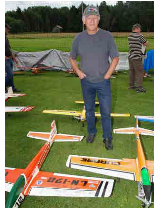
Ernst Totland kom med två modeller, dels en nybyggd Curare (hans tionde i ordningen) samt hans egna konstruktion, Miss Norway från 1975. Båda kärorna är byggda på lösvirke och med var sin Webra Speed i nosen.
