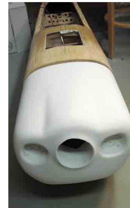
Plugg av cellplast för gjutning av form.
