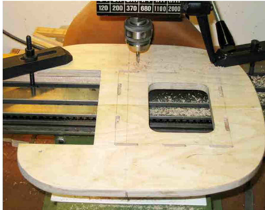
Fräsning av spår i brandvägg för motorkonsol.
