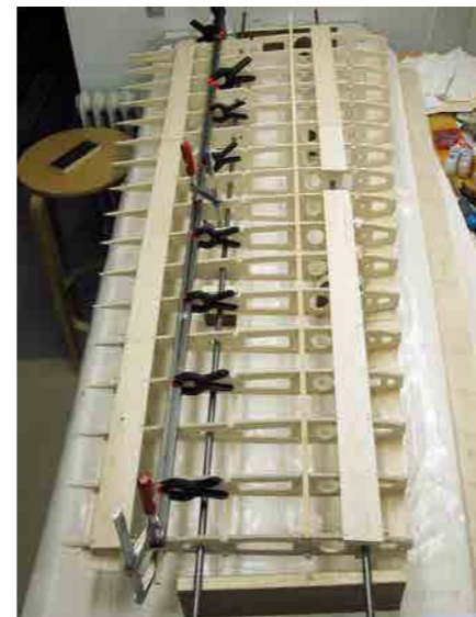
Två stålstänger ger rak vinge.
