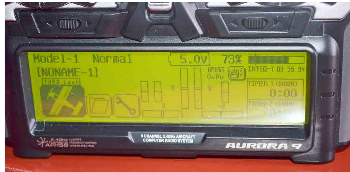
Här ser vi att mottagaren får 5,0 volt, genom den Telemetrifunktion som är inbyggd.
