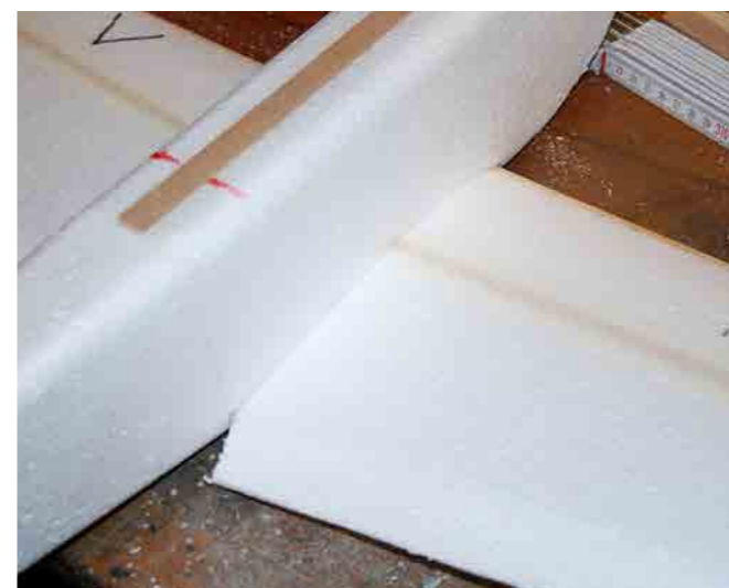
Vingen passas in mot kroppen. Här syns även vingbalkarna som limmas med PU-lim och maskeringstejp.
