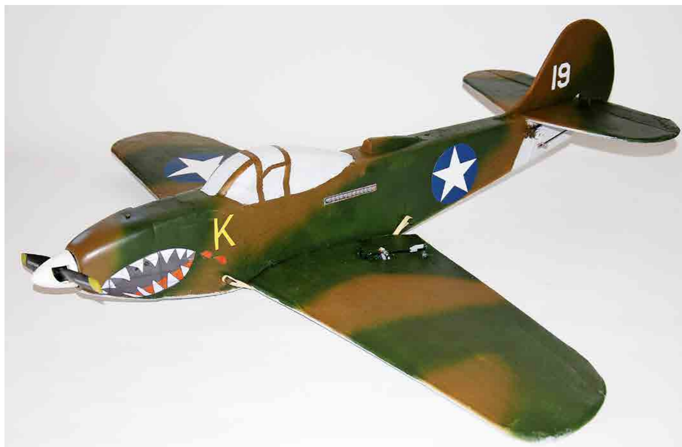
Så här blev modellen installerad och färdigmålad. Dekaler togs från sidvy på internet och skrevs ut i rätt skala med hjälp av färglaserskrivare.
