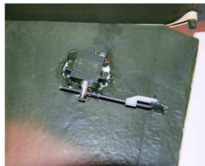
När man klär med brunpapp kan det bli skrynklor i klädseln på sina ställen. Dessa slipas enkelt ned med ett sandpapper.
