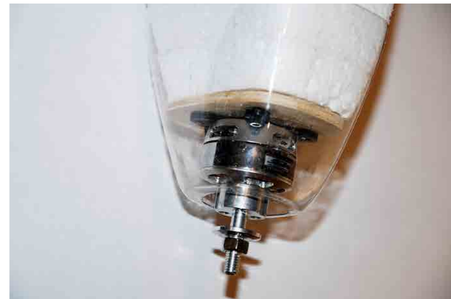
Motorinstallation innanför motorkåpan av PET-plast.
