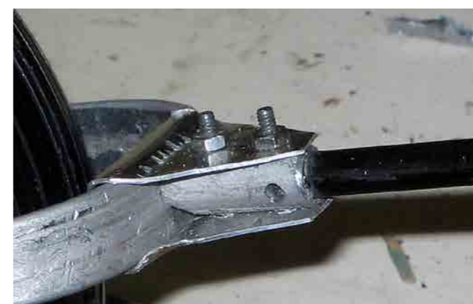
Tillverkning av skruvögglor till kolfiberstag.
