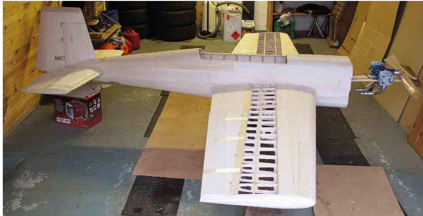
Här väger jag av modellen över TP och får hur långt fram motorn skall placeras
