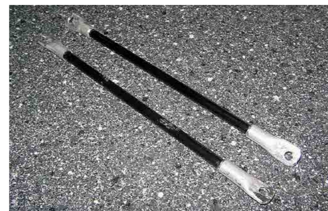
Tillverkning av skruvögglor till kolfiberstag.
