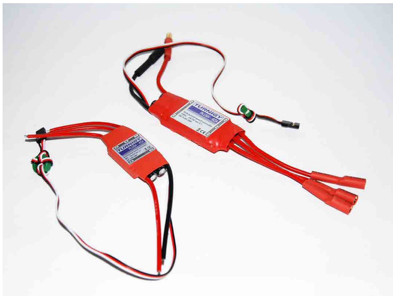
Fartreglage med inbyggd BEC. Lämplig storlek är 40A för .15 och 60A för .25.
