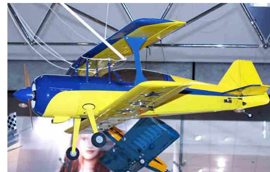
PITS S12 spännvidd 1300 mm, el-motor och 6 cells ack på 4Ah. Ägare Bo Olofsson.
