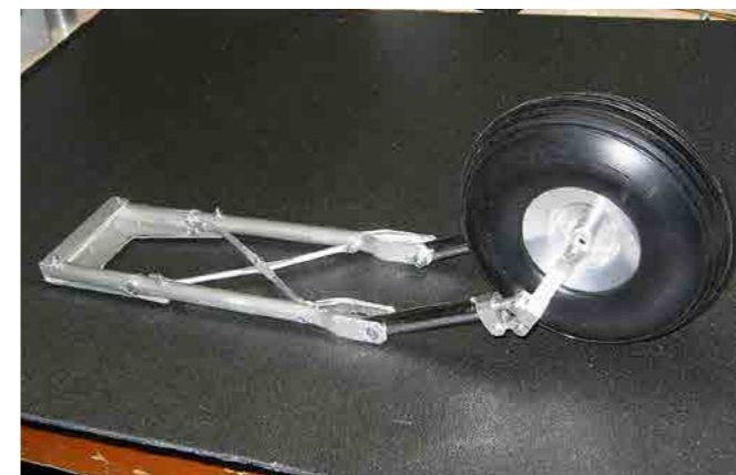
Landningsställ till DC-3 av aluminiumsmide.
