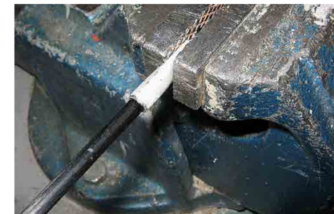
Tillverkning av skruvögglor till kolfiberstag.
