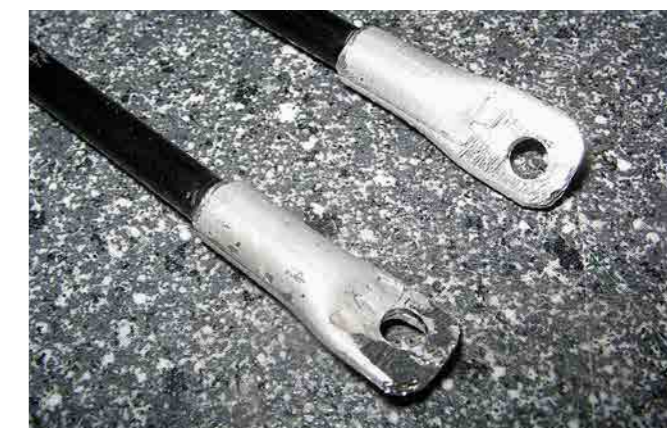
Tillverkning av skruvögglor till kolfiberstag.
