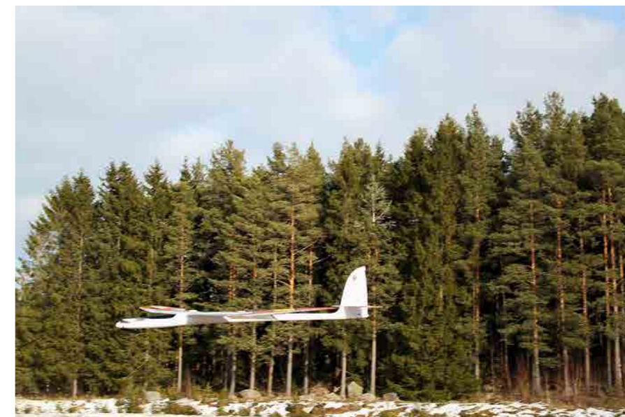
Omnikronen inför landning. Modellen blir stabil när man fäller ut butterflybromsen men den svarar sämre på skevrodret. Man får använda sidrodret istället om man vill justera riktningen på "flygbanan".
