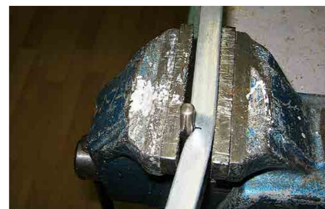
Knäckning av mittbalken för att få V- form.
