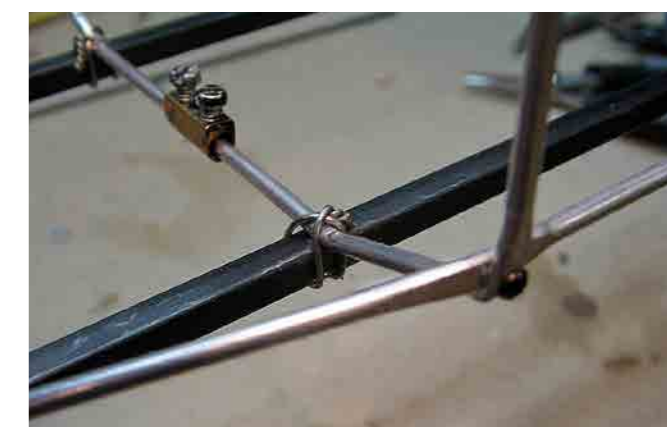
Olika teknik för sammanfogning av svetrådssmide.
