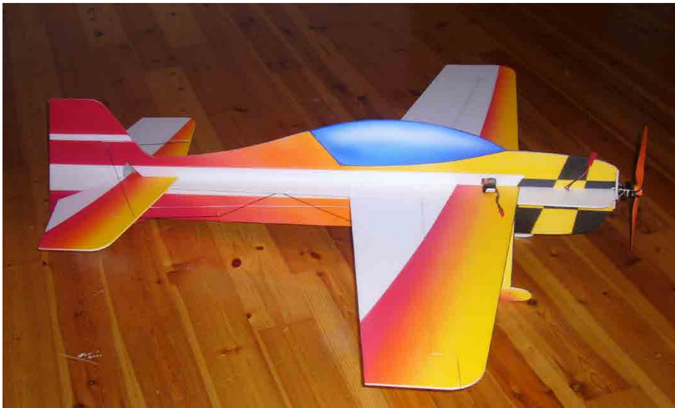
En modell för avslappnad flygning. Lätt utrustning och material ger låg vikt. 105g med batteri.
