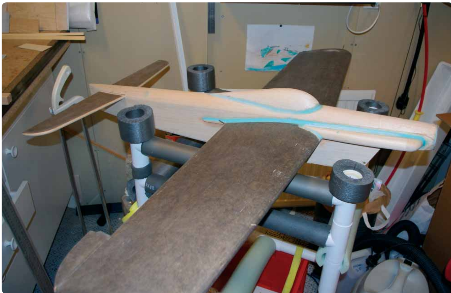
Figur 1. Vingrotsutfyllnader gjorda med Brodak "Super-fill". Lättarbetat och lättslipat.
