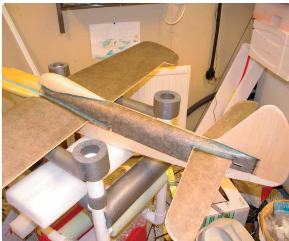
Figur 2. Kolfibermatta på kroppens ovansida. Mattan följer väl kroppen när den dopas fast. Var noga med att få bort alla eventuella luftblåsor.
