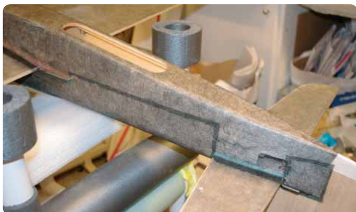
Figur 3. Överlappning av klädsel. Lägg gärna ett eller två lager dope under i skarven för att få bra fäste.
