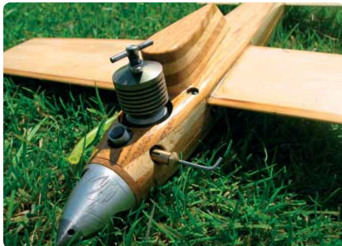
Dansk Minispeed-modell utrustad med en PAW 1 cc. Notera hur väl motor, spinner och kropp bildar en enhet.
