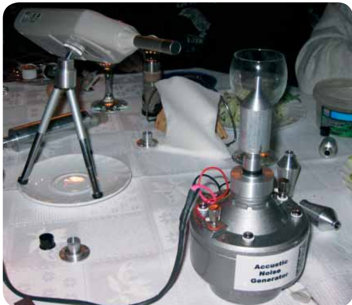
Testutrustningen består av en frekvensgenerator och en "högtalare" där man ansluter den ljuddämpare som ska testas samt en decibelmätare. Först gör man dock en mätning utan dämpare där värdet jämförs med de man får med dämpare.
