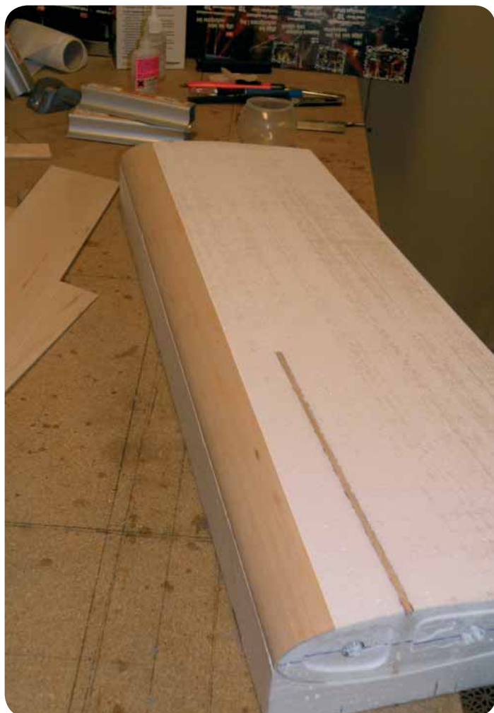
Plankning av framkant.
