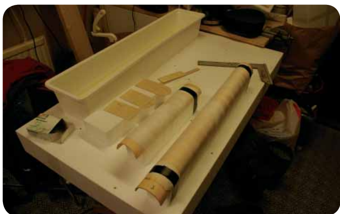
Kroppens ovan delar formas. Blomlåda (utan dräneringshål!) fungerar bra som vattenkar för blöttläggning av balsafliken.
