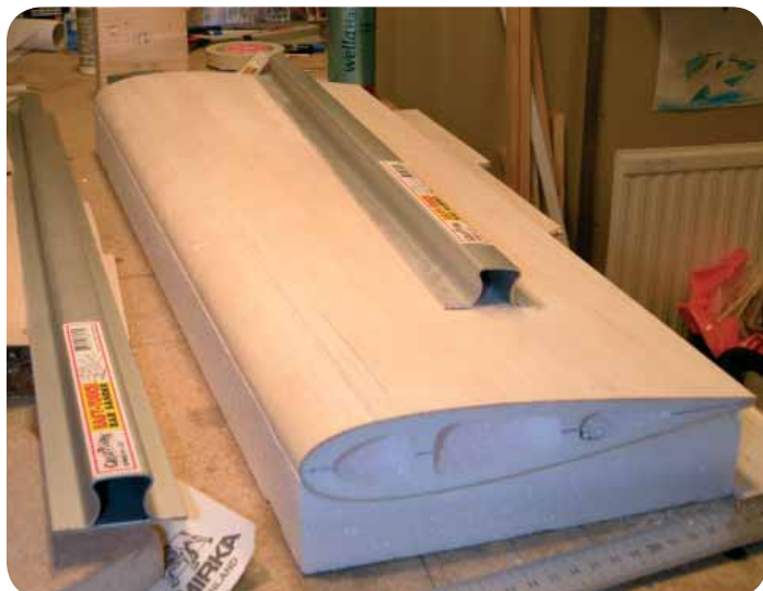
Slipning av färdigplankad vinge.
