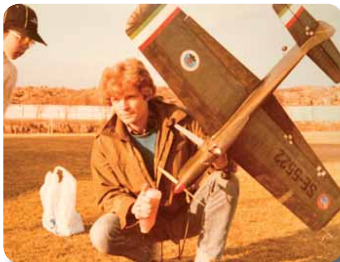
Jag tankar min tredje Nobler, även den modifierad med Nakkeliknande kropp och andra vingtippar. Motor OS 35 S.
