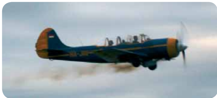
Vid invigningen blev det flyguppvisning av en JAK 52. Den började tillverkas 1976 och används mest som skol- och akrobatikflygplan. Till dags dato har ca 1800 byggts och tillverkningen sker numera i Rumänien. I nosen sitter en 9-cylindrig stjärnmotor som ger ca 360 hk och en maxfart på 285 km/h.
