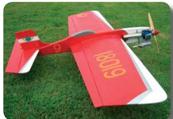
Leif Sundvalls "Circus King" med inbyggd tank och OS .40 LA-motor.
