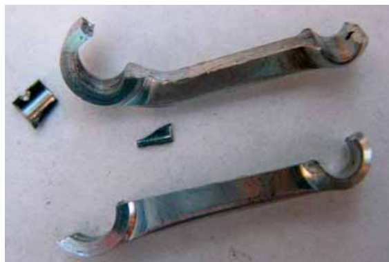
Det är inte ofta man ser en sådan klockren klyvning av en vevstake. Normalt brukar den ju splittra upp sig i stor- eller lill-ändan.
