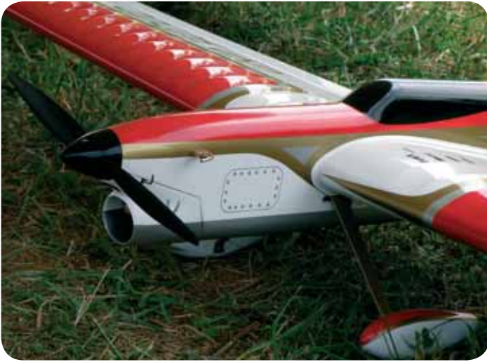
Paul Walkers (USA) Impact är något större än originalet. I nosen sitter en RO-Jett 65 med pipa.
