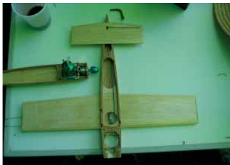
Dissekerad dansk Minispeed-modell. Oket är åtkomligt för byte av linor
