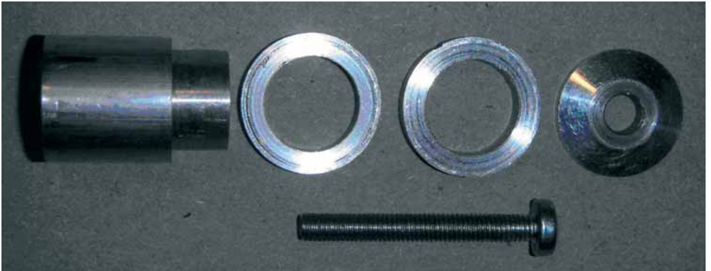
Bild 2. Verktiget som håller ringen då den bearbetas.
