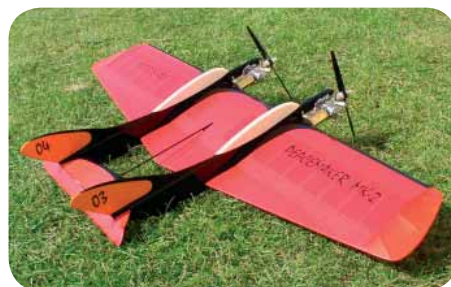
Clamer hade med sig en Peacemaker Special med 2 st PAW 1.5 cc dieselmotorer. Som vanligt med Clamers modeller var det ett utsökt bygge.
