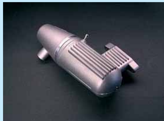
Ljuddämparen väger 104 g och bör kanske ersättas med ett lättare alternativ.
