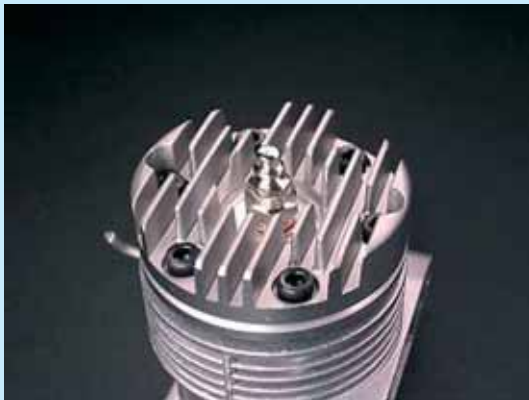
Hemsidan pratar om en "two piece cylinder head".
