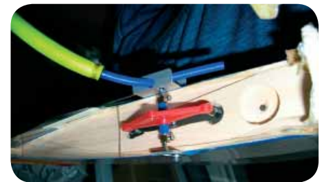
Roderoket sitter fast i avstängaren som i sin tur sitter fast i mittsprygeln. Montage på befintliga modeller är möjlig.
