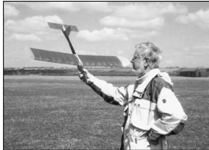
"Kalle Glader" är en annan S1:a från 1945, en hårdträkonstruktion av Sven Salenius och här byggd av Sten Persson. Ritning i OLDTIMER 2/1995.
