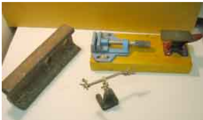
Dunka och slå måste man göra. Ut och såga upp en bit järnvägsräls. Utmärkt både som stöd och tyngd vid t ex limningar. Att montera ett minis-täd och ett litet skruvstycke på en plankbit gör de mer lättanvändbara. En hållare med griparmar hjälper till när ens egna förmågor inte räcker till.
