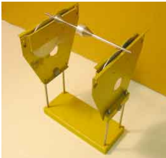
Mäter man propellern måste den också balanseras. Faran med en sådan mätare är att man upptäcker hur obalanserade många köpepropellrar är.
