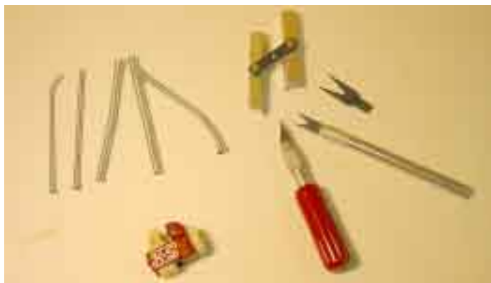
Hur böjer man ett rör snyggt utan att det går av? Jo, genom att använda en rörböjarsats. Kapar små rör gör man bäst med en rörkapare. Hål för rodergångjärn görs elegant med verktyg som både hjälper till med centreringen och att få ett fint hål.
