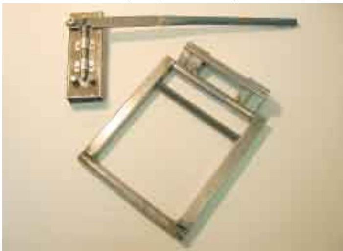
Jiggar för att bocka piantråd (landningsställ) och plåt (tankar) är ovärderliga att ha. Dessa är av fabrikat Rudolf Ross.
