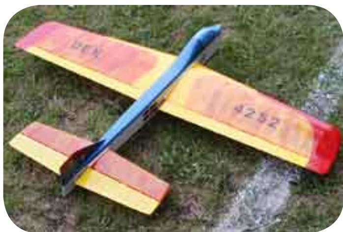
Dan Hune. Double Star .60 med Brian Ether 12x4,5 trebladig kolfibersnurra.
