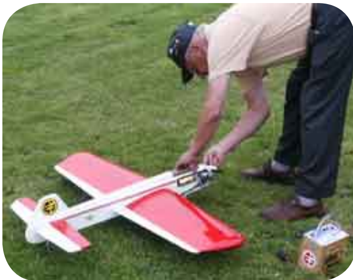
Rudolf Ross var inte nöjd med motorgången. Tyckte det var svårt att hinna träna även som pensionär p.g.a. mycket klubbengagemang. Rudolf flyger med sin egen design: Röde Rudolf med uppbyggd kropp (Gieseke Nobler vinge i cellplast och Banshee stabbe) med sidmonterad O.S. .40.
