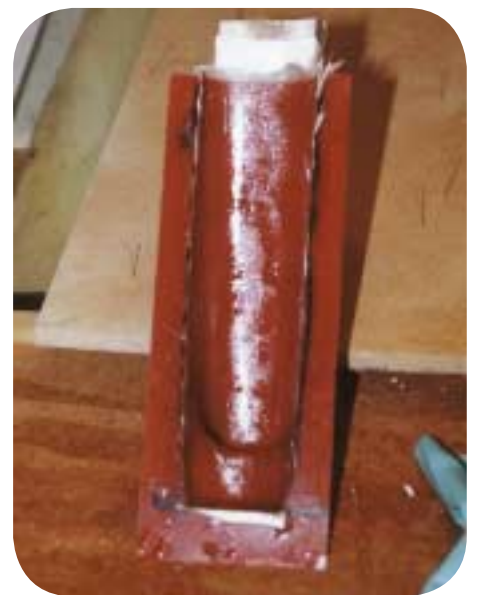
Alla lager är ilagda, nu är det bara att vänta på att epoxit skall härda. När epoxit är härdad kan kåpan tas ur formen. Det kan behövas lite mildt våld och en del lirande. Var försiktig så du inte knäcker kåpan.
