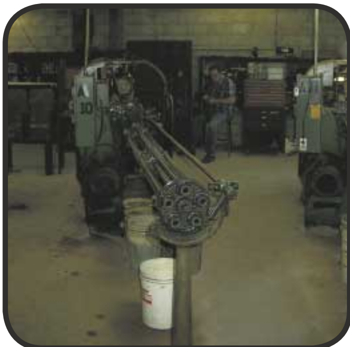
Tillverkning av fallskärmsringar. Råämne i stavform i rören.
