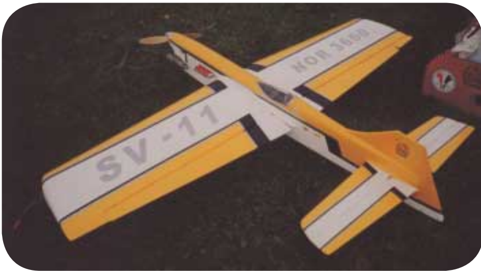
Ingolf Steffensens SV-11: Mica film klädda vingar, roder och kropp klädda med glasfiber och lack. Vikt 1.750 g. ST .51 modifierad av Tom Dixon. Snygg kärra!
