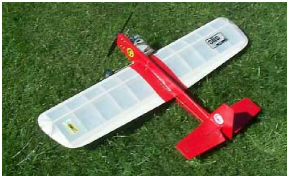
Kommande linflygaren Ludwig Löfroth, 6 år flög mellan tävlingsomgångarna. Modellen är en SIG Akromaster med OS 15. Vingen är klädd med Polyspan.
