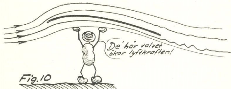
En välvd platta följer luftströmmen bättre och avböjer den mera nedåt. Lyftkraften blir större i förhållande till motståndet än för plan platta.
