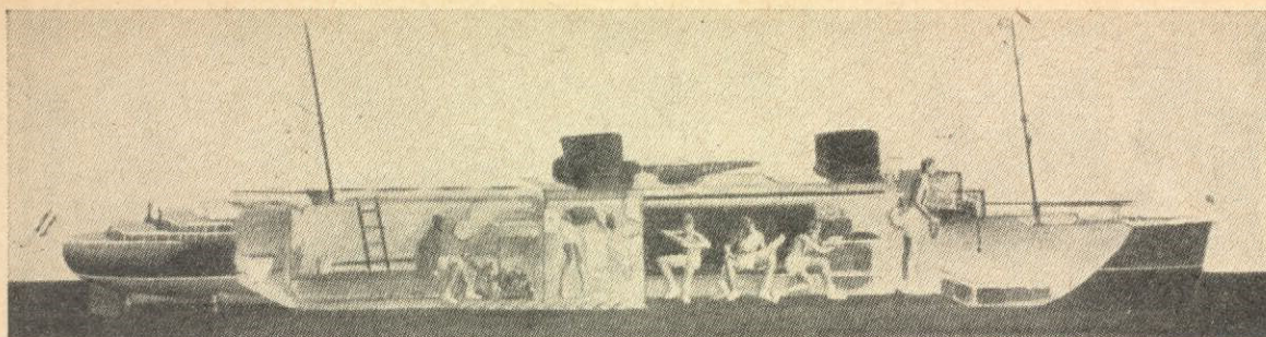
Längdsnitt genom jättemodellen »Bremen». 1. Styrhytten. 2. Salongen. 3. Tvättrum. 4. Maskinrum. 5. Toalett.
