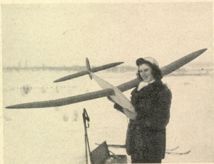
T. h.: »Camilla» i skönt sällskap i väntan på luftning. Modellen är klädd med japonsiden. Spännvidden är 218 cm.
