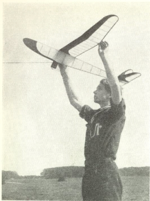
28. Medhjälparens utgångsställning vid högstart. Flygplanet fattas vid tyngdpunkten med höger hand och stöttas eventuellt i ena vinghalvan med vänster hand. Nosen hålles högt. Vingen hålles under starten vågrätt och medhjälparen följer modellen, tills han känner att den bär sig själv, då den släppes och lämnas att stiga. Jämför bild 32 på sidan 55.
