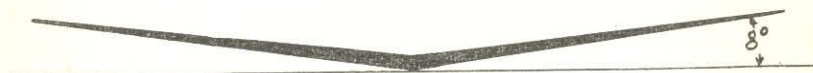
13. V-formad vinge sedd framifrån. Vinkeln mellan vingen och modellflygplanets tväraxel (se sidan 31) bestämmer V-formens storlek. I det här fallet är den 8° (grader).
