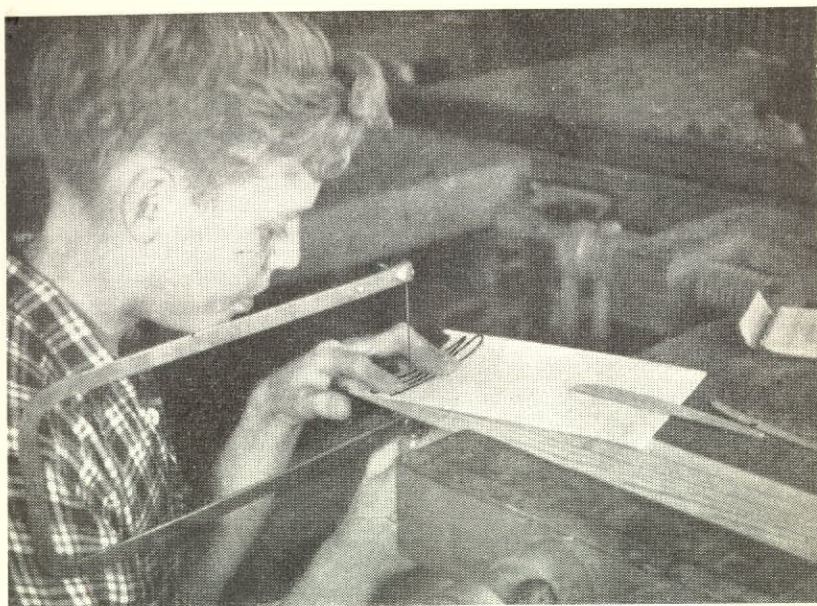
35. Utsågning av vingspryglar. Arbetsstycket läggs an mot sågbrädan, medan lövsågen föres lodrätt upp och ned. Sågbladets tänder skall vara nedåtriktade. Den som sågar bör sitta med sågbrädan några centimeter under axelhöjd.
