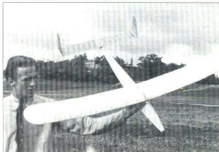
Wakefieldmodell konstruerad av Hans Schmiterlöv. I nosen sitter en kuggväxel. Gärdet 1942.
