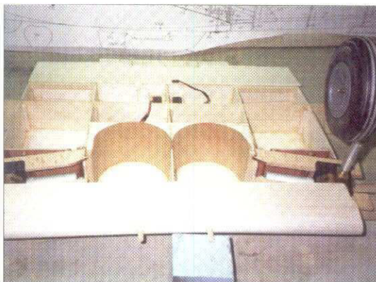
Vingens mittsektion — första byggmomentet med de infällbara ställen, som fälls in något bakåt. Eurokit-ställen drar in ställen med luft och de fälls ut med fjäderkraft — extra säkerhet om något skulle hända.
