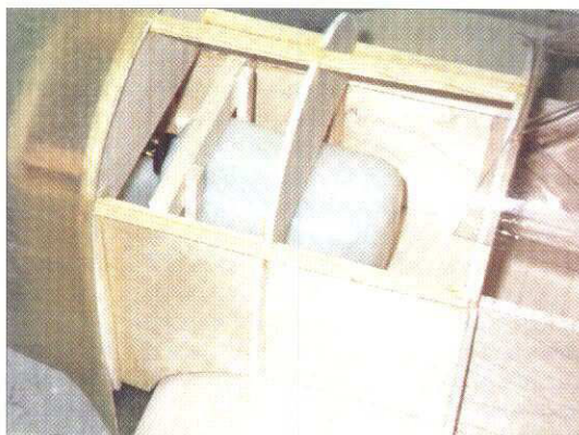
Tanken monterades innan framkroppens överdel plankades.
