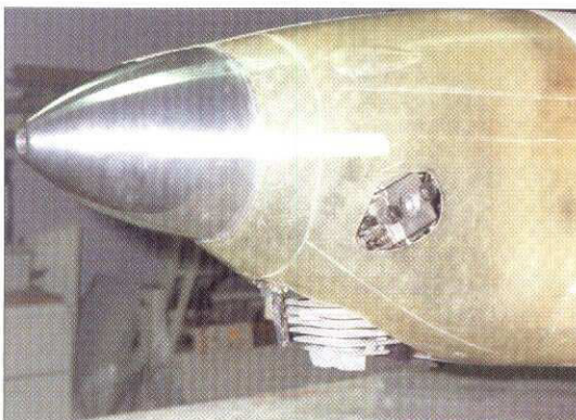
En första kontroll av nospartiets detaljer. Motorn passar fint in i kåpan med minimal håltagning.
