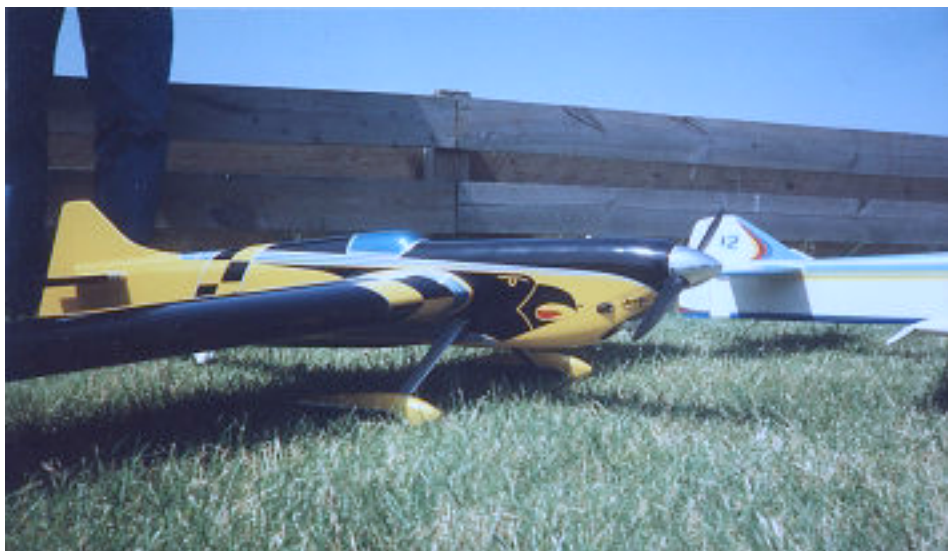
Eriks konverterade Kestrel, nu med Aldrich/Jett 50 RE och Aldrich-pipa. Det lilla kolfiberröret i motorkåpan (ett på varje sida) leder kylluft direkt till avgaskröken.
