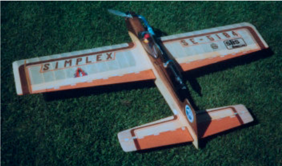
Kaukos "minimalistiska approach" = Enkel modell rak framkant, gammal OS40 FSR stående, billig CF pipa (Malila), vanlig propeller – När allt funkar som det ska känns det inte så stor skillnad på den här och Blue Max'en", påstod Kauko!
