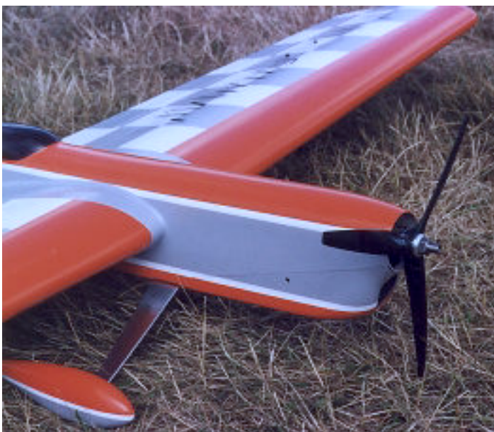
Staffan Ekströms fina Millennium/PA.51 flög bra i den bitvis tuffa vinden. Han flög utan spinnern för att få tyngdpunkten rätt placerad.
