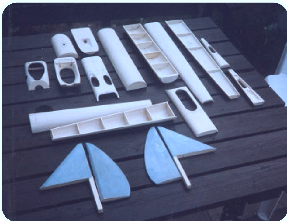
Diverse kroppsdelar. Bl a är botten- och topplock av formgjuten balsa. Det är både lättare och billigare än urholkade tjocka flak.
