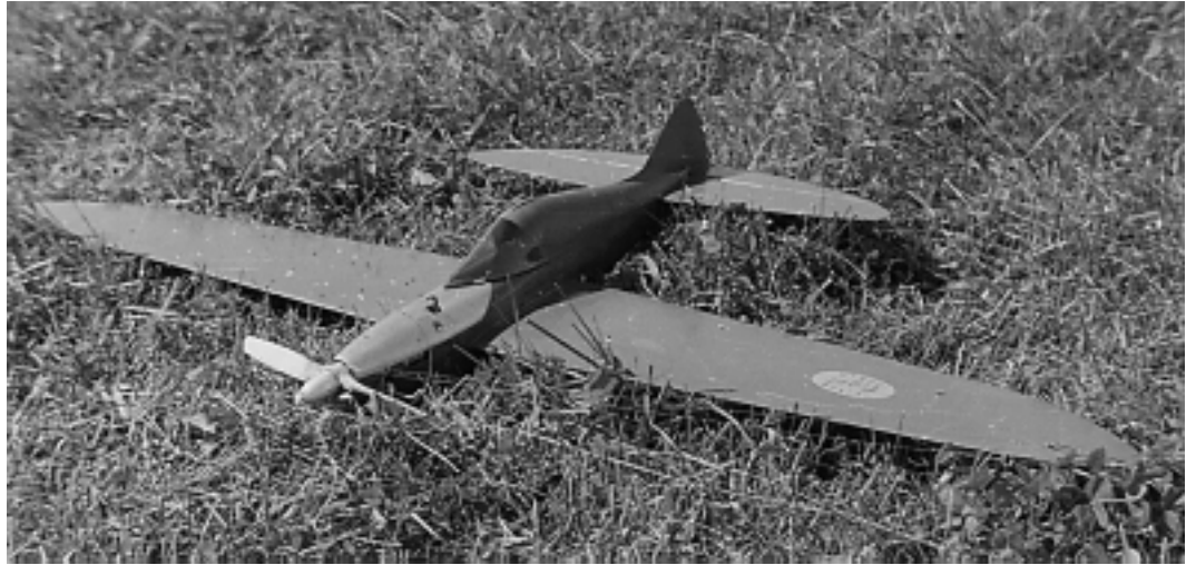
Norsk mono-wheel team-kärra med linorna runt propelleraxeln.
