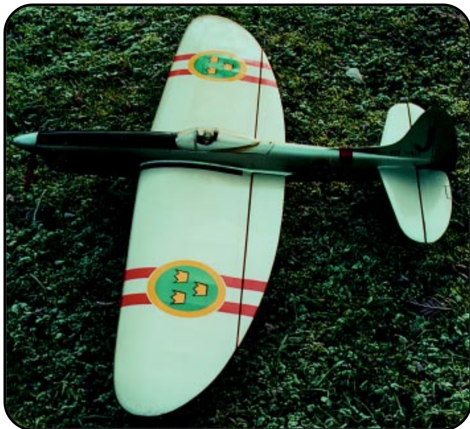
Smoothien är utrustad med en Fox 35 utan ljuddämpare. Planet är klätt med siden och är i förvånande gott skick efter drygt 40 år på nacken tack vare polyuretanlack.
