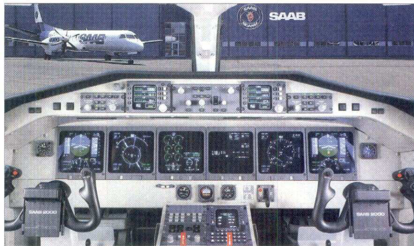
Cockpit i SAAB 2000 med lättavlästa displayer, där det mesta presenteras — motorvärden, höjd, kurs, fart, vind. I två av displayerna visas också de inknappade flygfyarna, där även flygplanets radarbild visas. I detta svseende är SAAB 2000 bland de främsta i världen!
