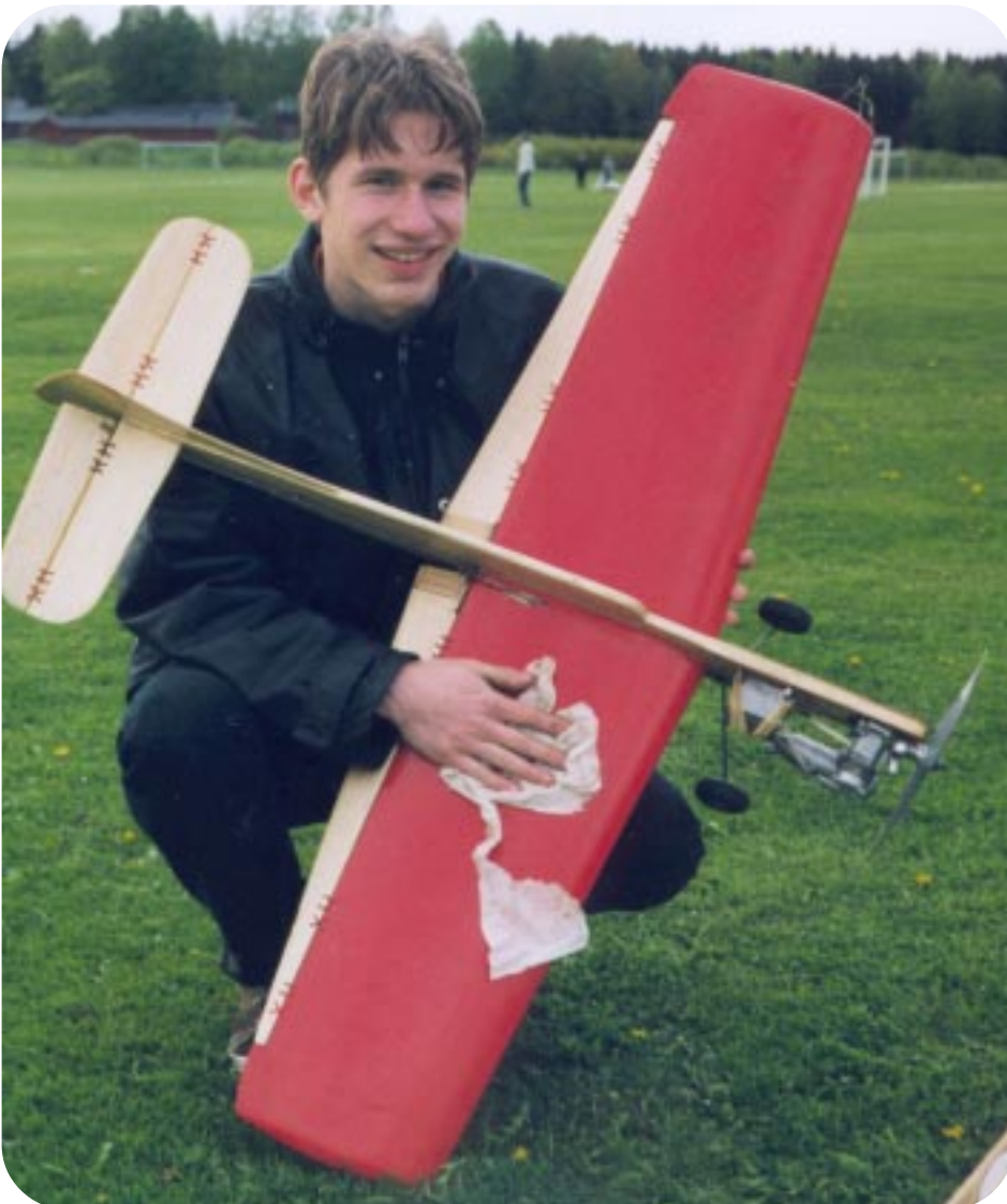
Lars-Åke flög med en Shoestring bestyckad med en K&B 3,5 och en TopFlite 9x5 trä.
