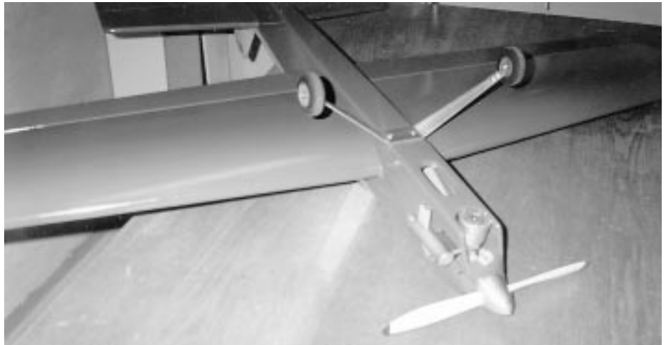
I nosen sitter som vanligt ST60 med superlätt ljuddämpare (under 30 g) från Tom Lay.
