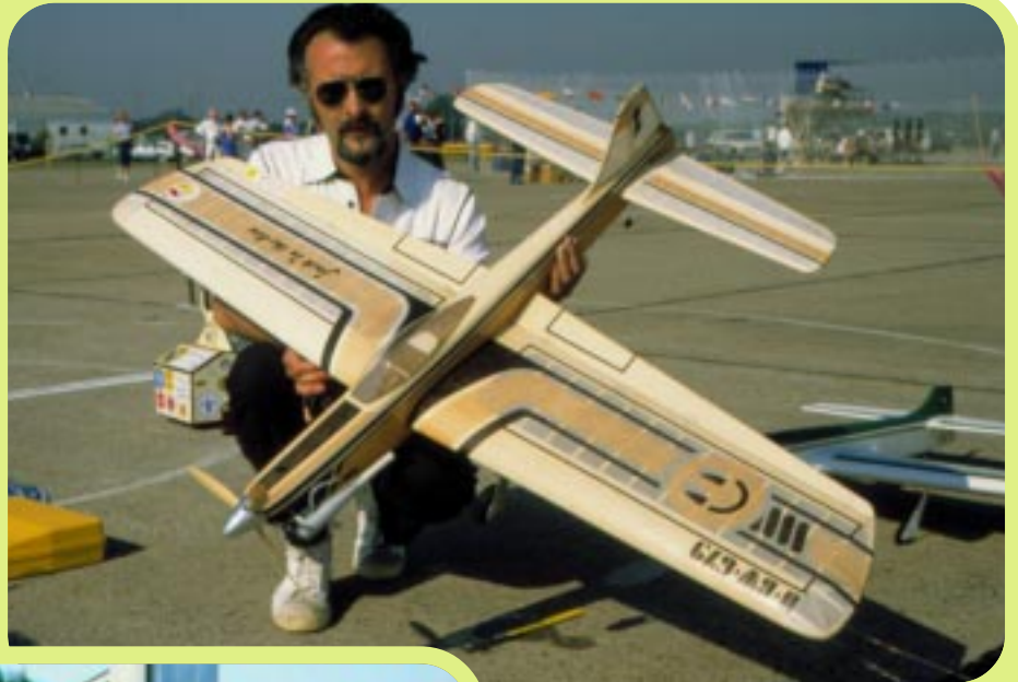
Claus Maikis vid VM 84, med som vanligt originell kärra (delbar). Klädd med vitt papper och dekor av färgat papper. Så brukade jag också göra förr i tiden, på mina små modeller. Sparar vikt och pengar.
