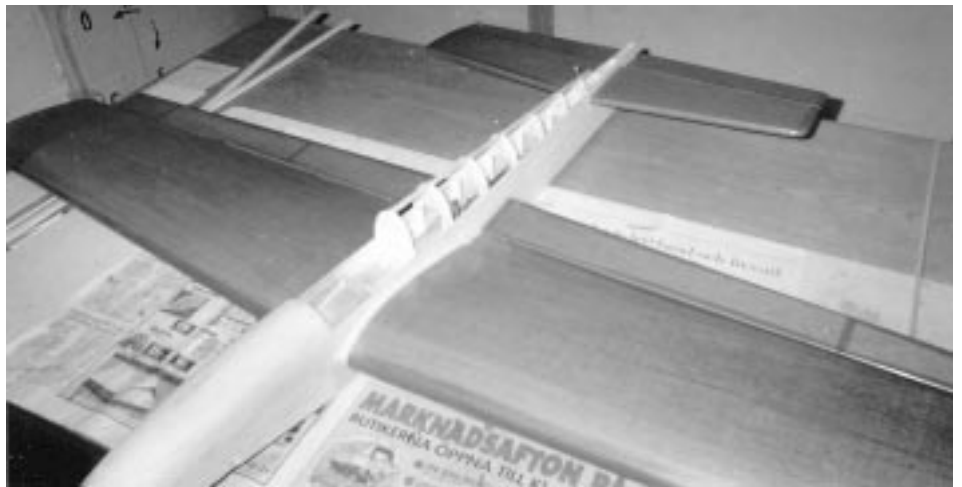
Med erfarenheter från den första Impacten har Ingemar modifierat den nya på flera punkter. Bl a glasfiberförstärkt vingens infästning i kroppen och styvare flaps gjorda av helplankad cellplast.
