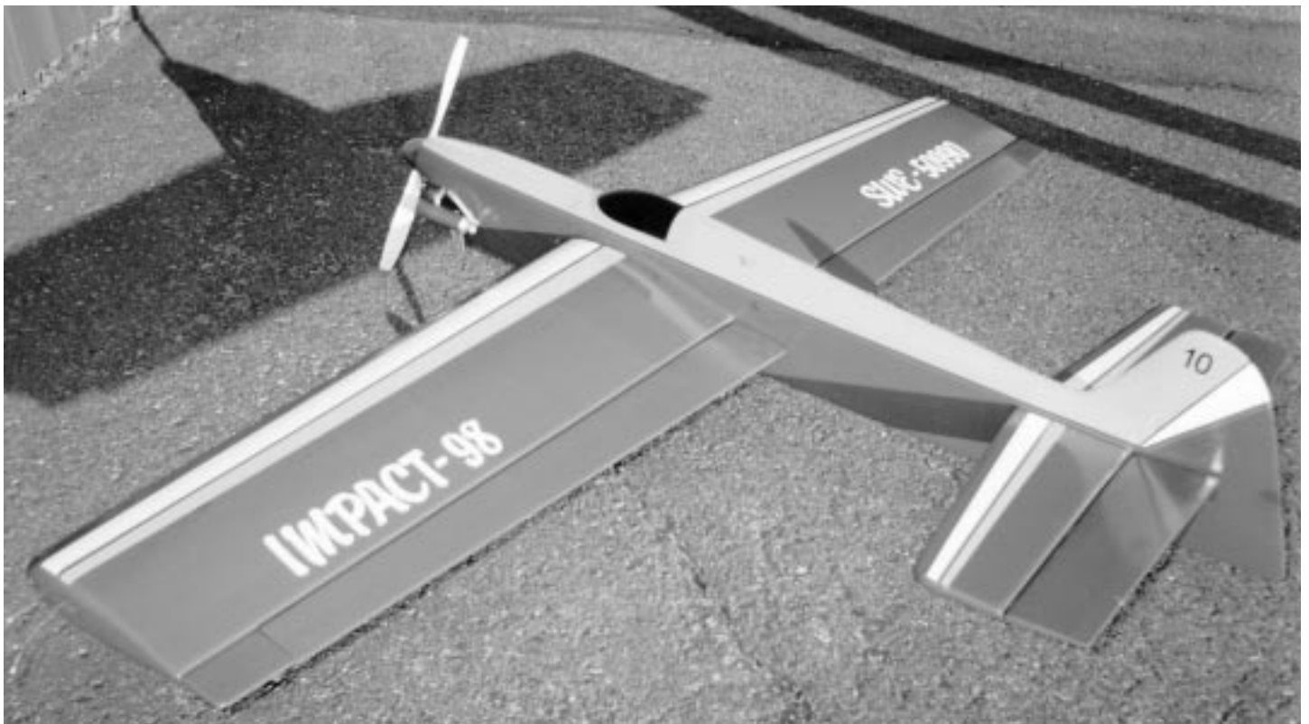
Impacten klassas som en modern stuntkonstruktion av världsklass och är lämplig för pipad .40-.60 eller dämpad .51-.60 motor.
