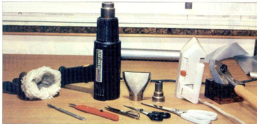
Sussis "trivsel"-verktyg, när hon klär med Solartex. Ett litet resestrykjärn med låg temp för större, släta ytor, ett mindre hobbyjärn med högre temp för mindre ytor. En varmluftspistol ingår också i utrustningen.
