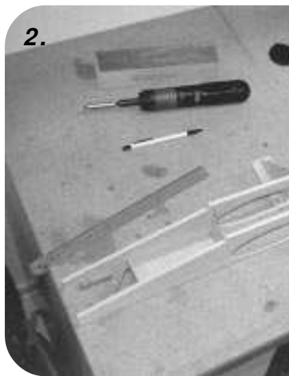
BILD 1-3: Med hjälp av ett flertal triangelformade stöd limmas kroppssidorna samman.
