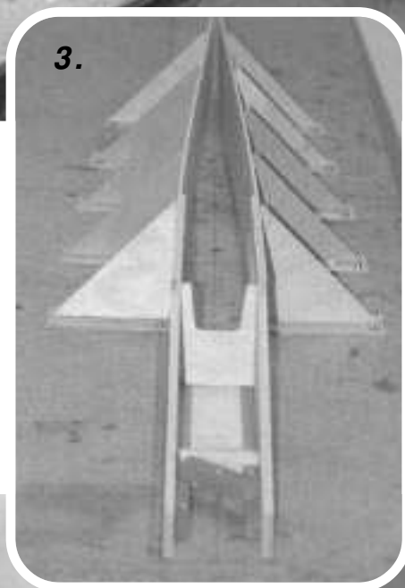
BILD 1-3: Med hjälp av ett flertal triangelformade stöd limmas kroppssidorna samman.
