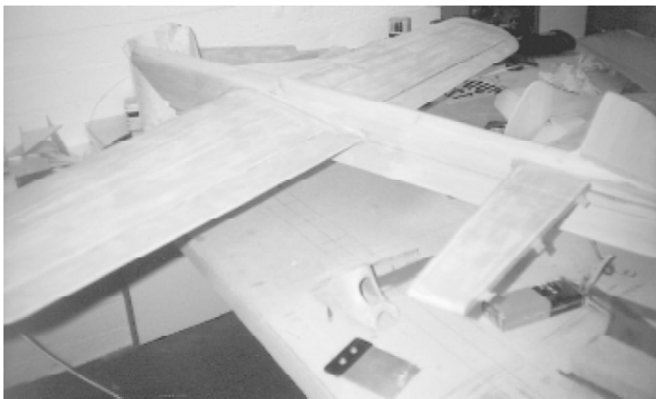
Första och sista gången jag använder Dupontprimern. Svårslipad som sjutton och väger en hel del. På bilden återstår att klä kroppen med Polyspan.
