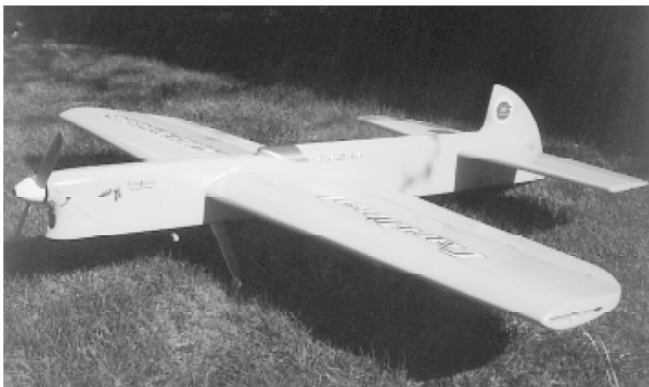
Min Cardinal är äntligen klar för premiärturen. 2 175 g blev slutvikten som naturligtvis är mycket men den flyger hela programmet utan problem med hjälp av Stalker Pro 61 RE och en B-Y & O 13 x 6 propeller.
