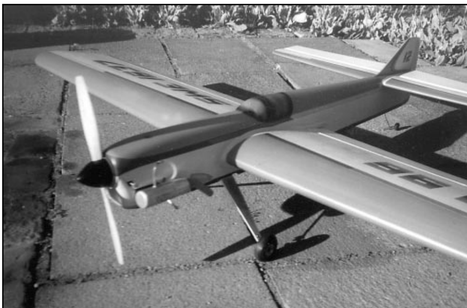
Pattermaster är en stor modell, spännvidd 60" (152 cm), vingyta ca 45 dm 2 , vikt mellan 1 900 och 2 200 g.
