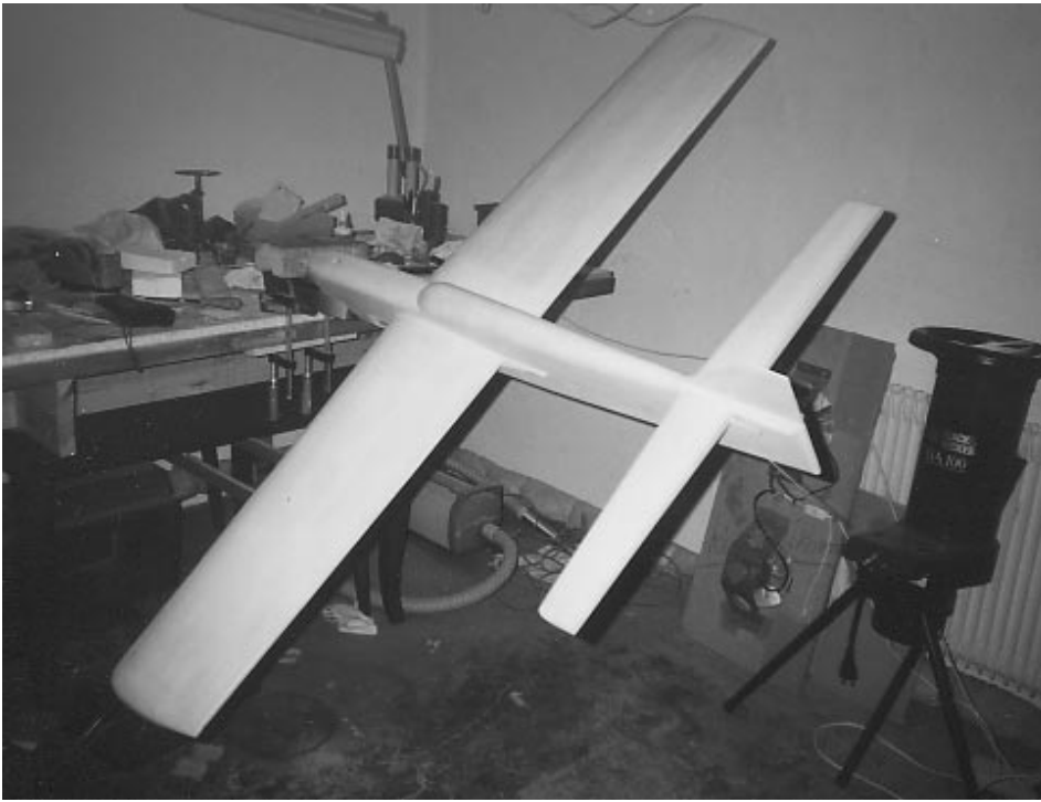
Patternmaster i målningsjiggen. Modellen kan snurras runt så att man lättare kommer åt i rätt vinkel med spruta eller pensel utan att hålla i modellen.
