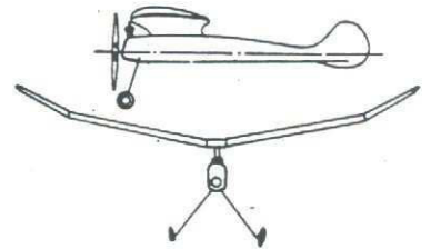
Gunnar Ågrens segermodell »GA 99» är av gammal beprövad konstruktion med baldakin och dubbel V-form.
