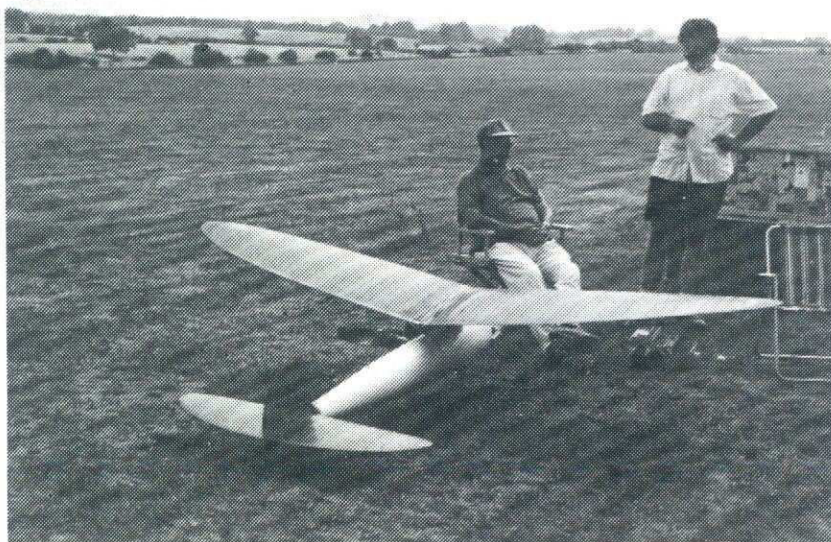
"Big is beautiful" - Här stämmer det! En Carl Goldberg konstruktion från 1937 med Brown J:r. Varje sprygel är uppbyggd på lister liksom alla balkar! Kroppen är helt balsaklädd, ändå är modellen lätt! Foto: S.-O.L.
