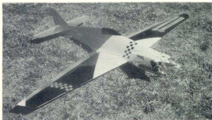
Kazen's typiska vinggeometri. Utanför skevrodret är vingspetsens bakkant uppslipad cirka 2-3 mm, vilket blir en cirka 1,5° wash-out. Kaze Killern - amerikansk mästare i F1, världsmästare i F3D 1991 och svensk riksmästare i Sport Pylon 1993.
