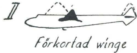
Efter ombyggnad med kortare krokaavstånd blev starten lätt. Tider på 3\frac{1}{2} —4 min. blevo vanliga.
